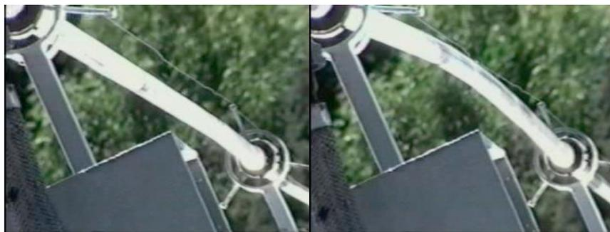
Figura 1.7. Tubo absorbedor en el eje focal (izquierda) y fuera del eje focal (derecha) [23].
