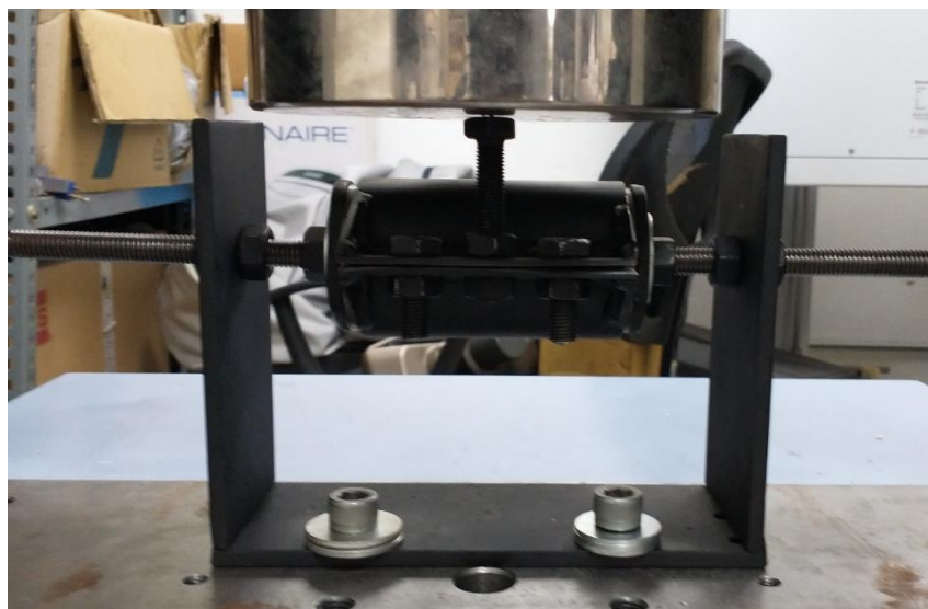
Figura 4.66 Montaje del banco experimental en la máquina universal.
