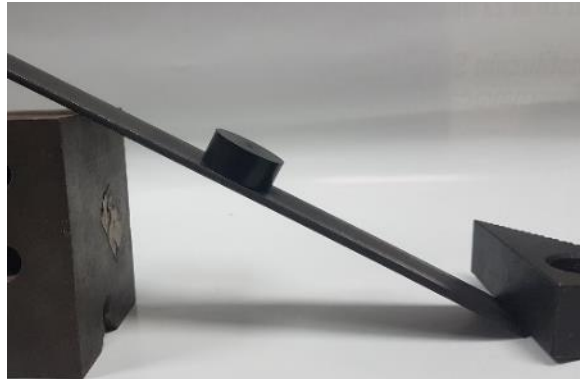
Figura 4.53 Prueba para obtención del coeficiente de fricción.
