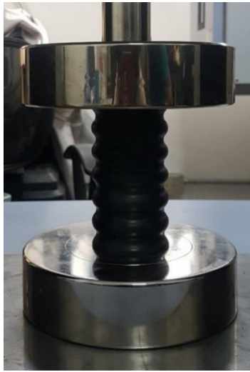
Figura 4.54 Montaje del elemento ondulatorio entre los platos de la máquina universal.
