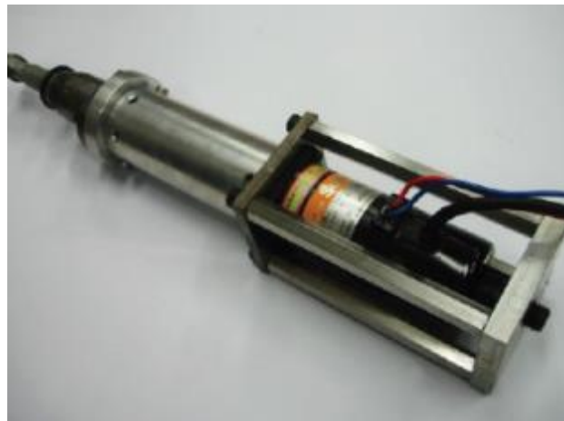
Figura 2.14. Prototipo del inersor (H. J. Chen et al., 2017).
