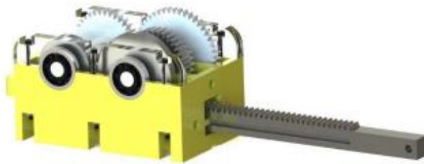
Figura 2.10. Inersor de una cremallera (rediseñado) (Barredo, 2016).
