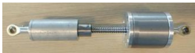
Figura 2.37. Diseño del inersor utilizado en (Siami et al., 2018).
