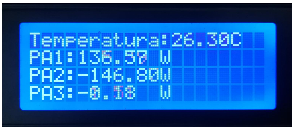
Figura 4.23 Resultados de las mediciones de potencia activa tomados por el prototipo (conexión errónea).
