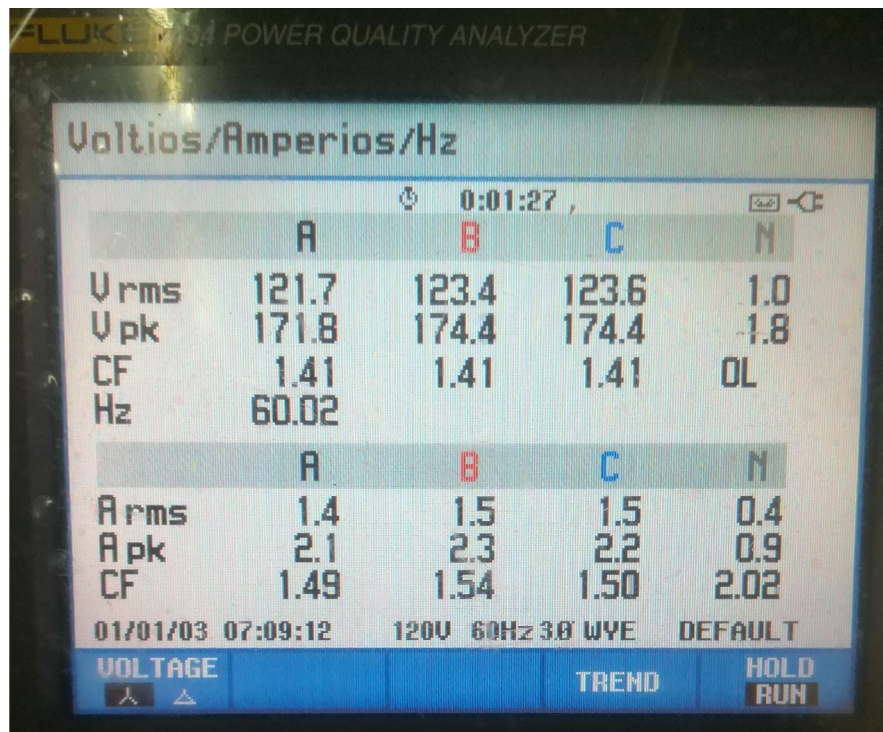
Figura 4.11 Resultados de las mediciones de voltaje y corriente tomados por el analizador de redes FLUKE (con carga).
