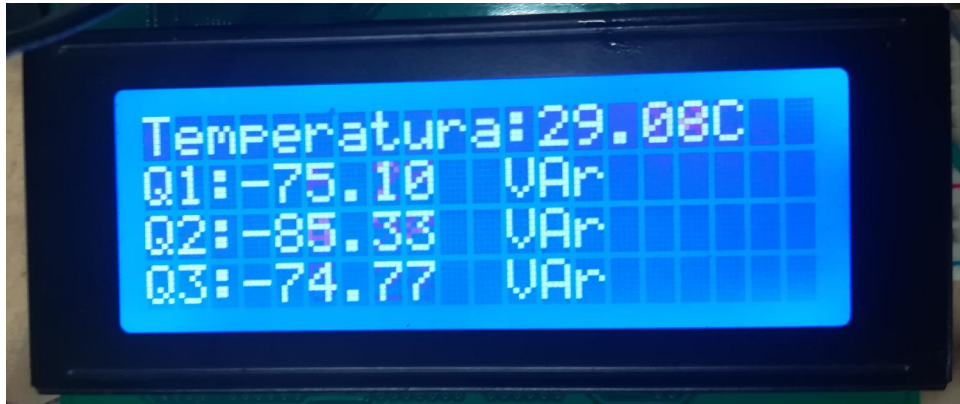
Figura 4.6 Resultados de las mediciones de potencia reactiva tomados por el prototipo (en vacío).
