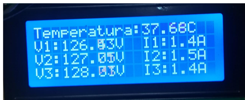
Figura 4.12 Resultados de las mediciones de voltaje y corriente tomados por el prototipo (con carga).
