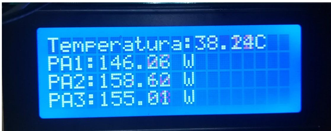
Figura 4.14 Resultados de las mediciones de potencia activa tomados por el prototipo (con carga).
