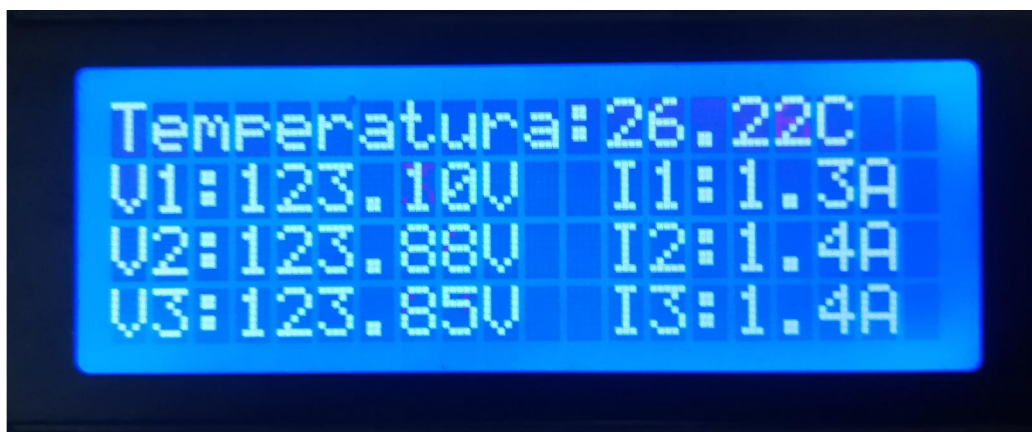
Figura 4.21 Resultados de las mediciones de voltajes y corriente tomados por el prototipo (conexión errónea).
