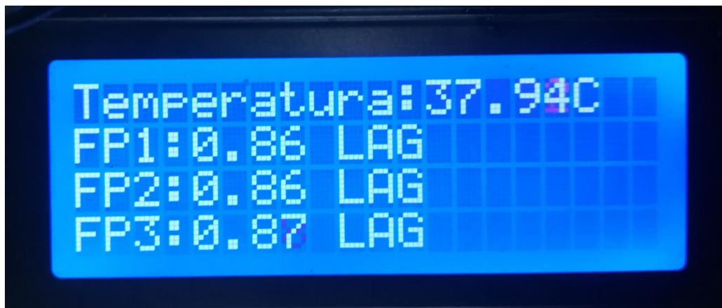
Figura 4.17 Resultados de las mediciones del factor de potencia tomados por el prototipo (con carga).
