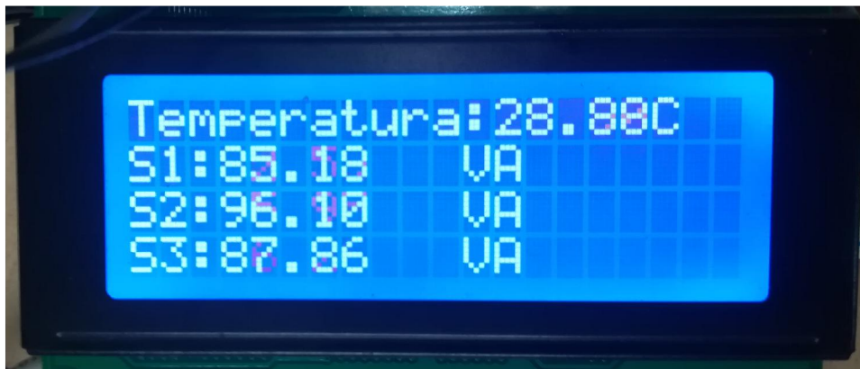
Figura 4.7 Resultados de las mediciones de potencia aparente tomados por el prototipo (en vacío).
