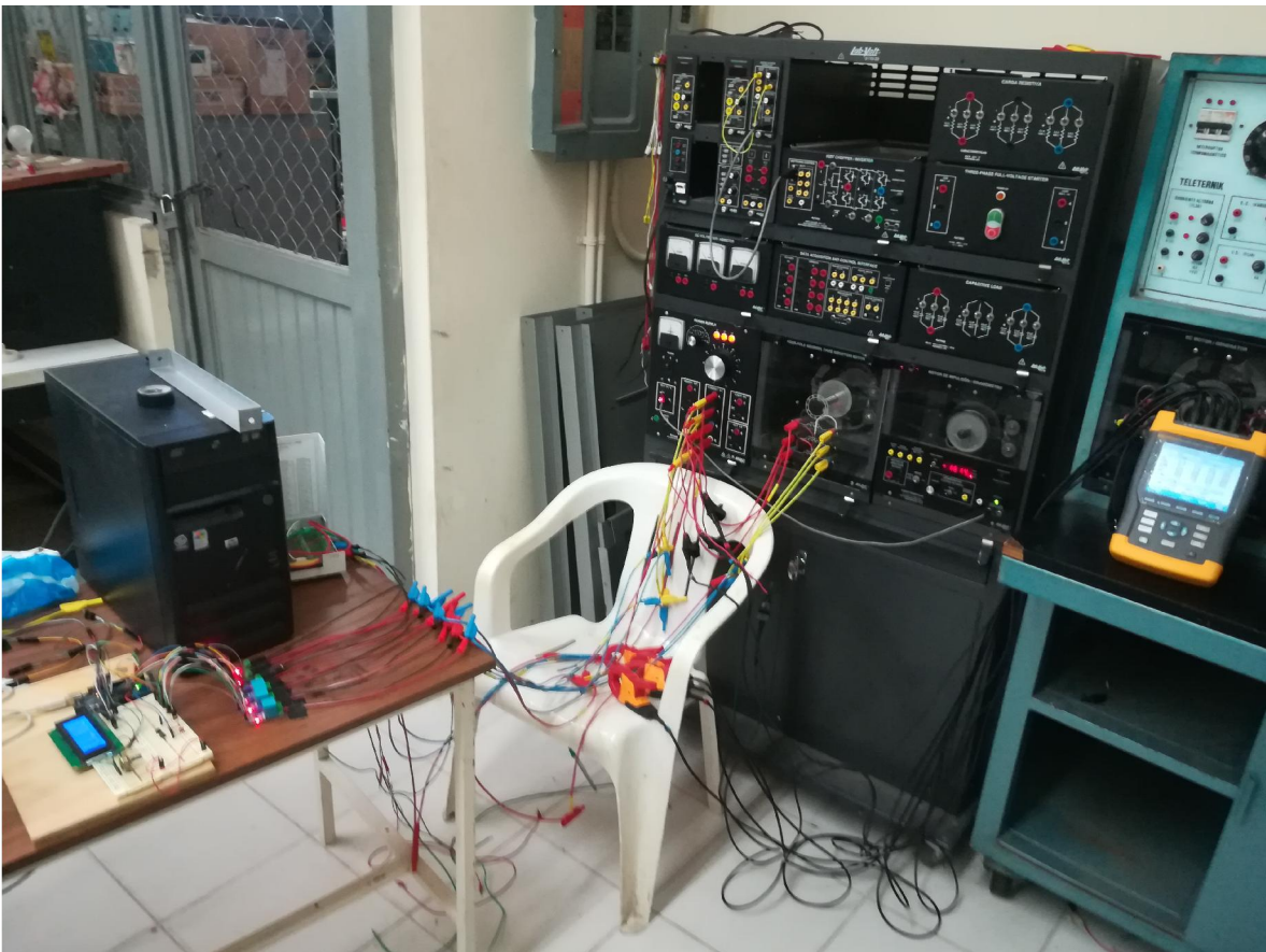
Figura 4.1 Conexión del prototipo y el analizador de redes FLUKE para pruebas con el motor.
