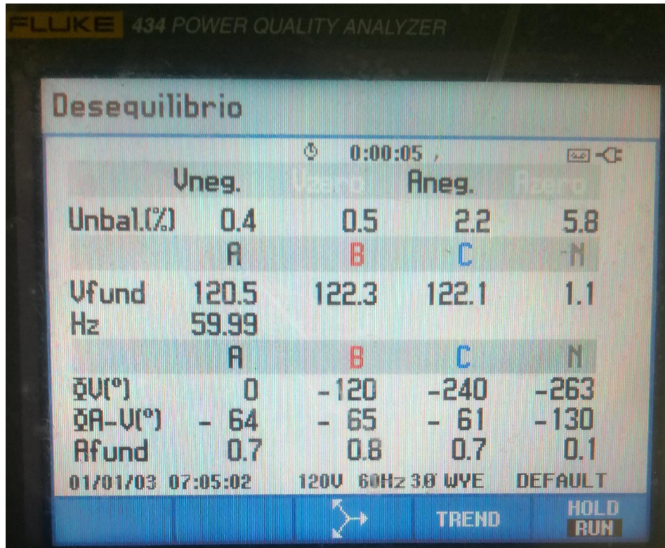
Figura 4.9 Resultados de las mediciones de ángulo de fase tomados por el analizador de redes FLUKE (en vacío).
