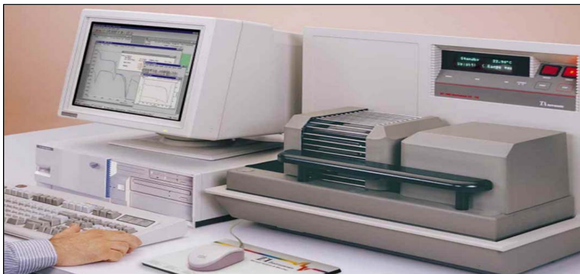
Figura 2.8 Analizador térmico TA Instruments STD 2960 Simultaneous DCS-TGA.
