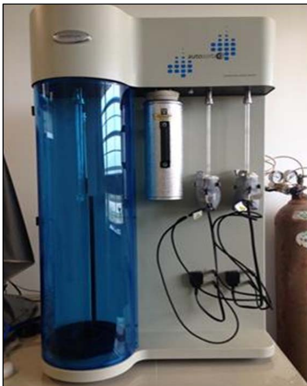
Figura 2.10 Equipo de adsorción de Nitrógeno Quantachrome Autosorb-iQ.
