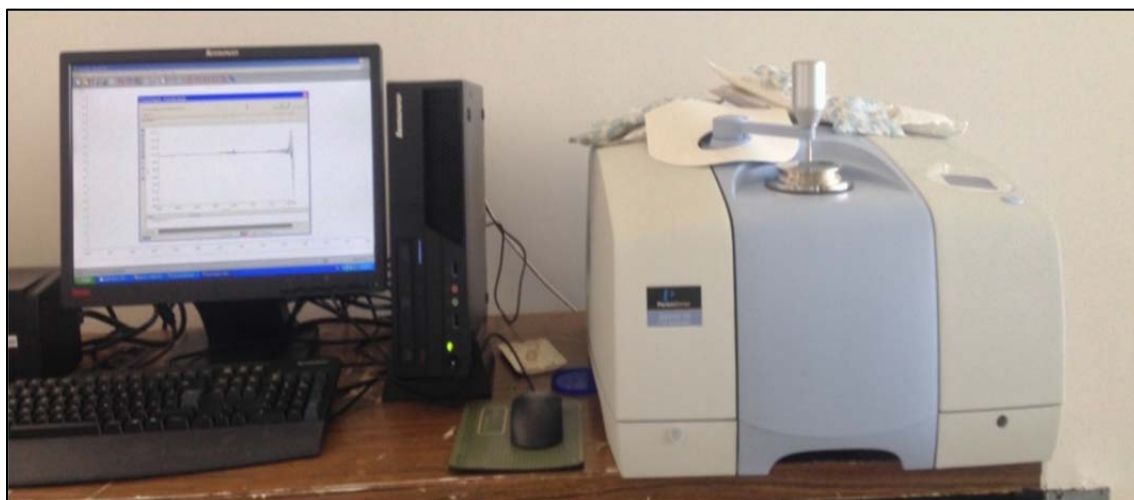
Figura 2.12 Espectrómetro Infrarrojo Perkin–Elmer Spectrum 100.
