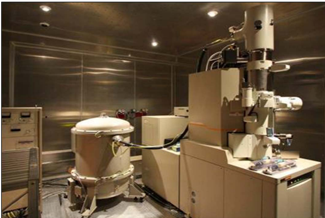
Figura 2.18 Microscopio electrónico de transmisión JEOL JEM-2200FS.
