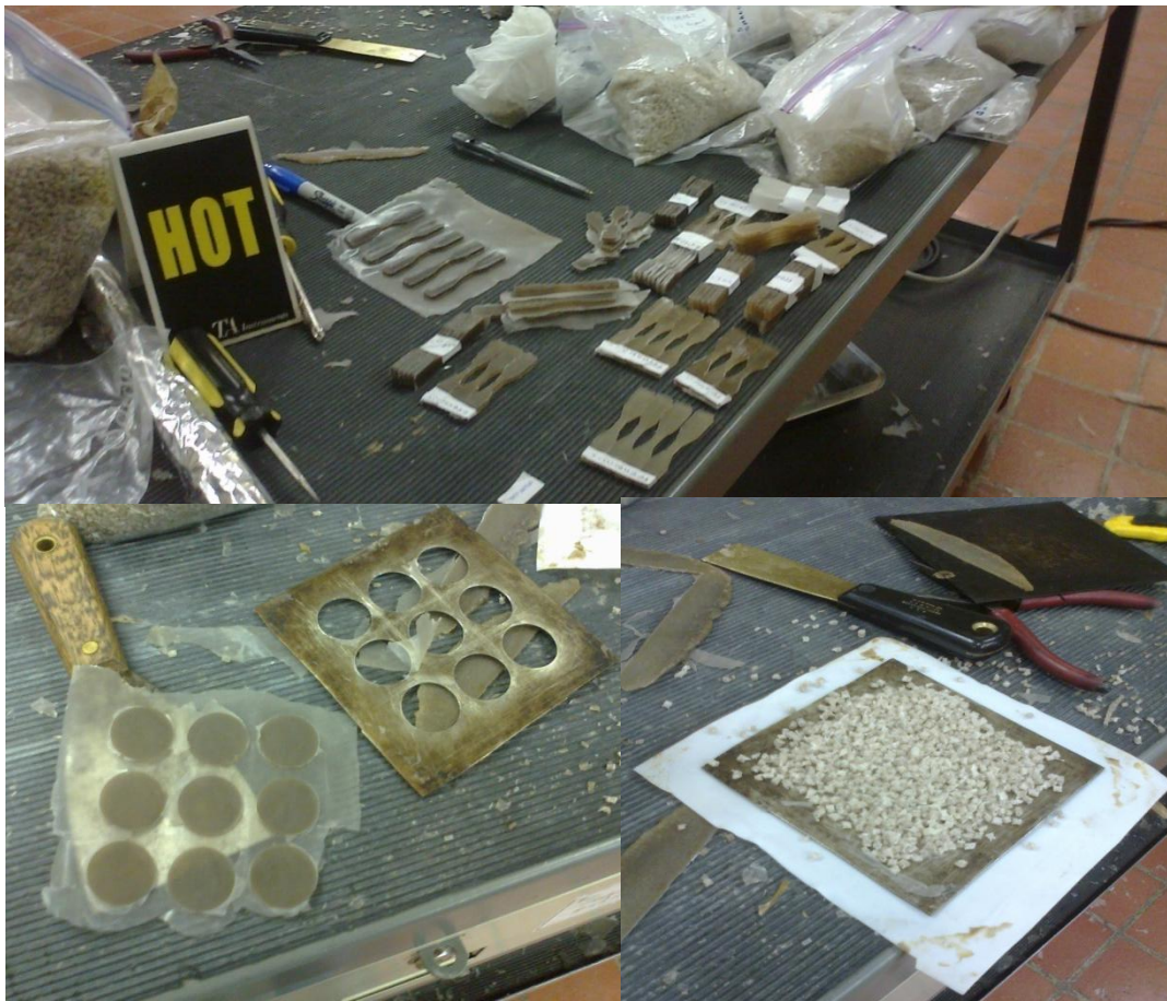
Figura 3.5.1.2 Probetas de tensión y tipo moneda para Impacto Gardner y DRX
