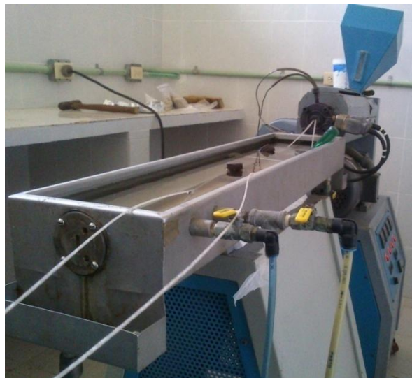
Figura 3.4.2.3 Extrusor Monohusillo Beutelspacher
