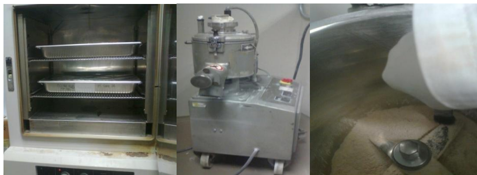
Figura 3.4.1.1 Estufa Imperial V y Mezclador Intensivo Henshel.
