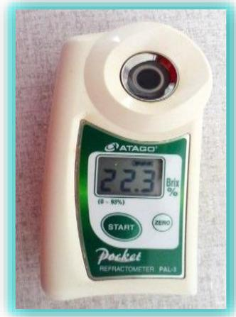
**Figura 15.** Refractómetro Atago – Pal 3, para °Brix.
