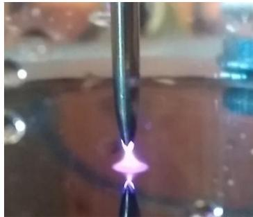
Figura 2.4 Descarga de plasma para el tratamiento con yodo.
