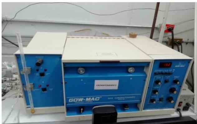
Figura 2.5 Cromatógrafo de gases Gow Mac 580
