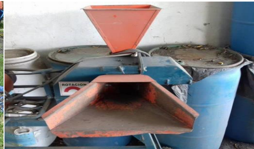
Figura 2.4 Molino de martillos
