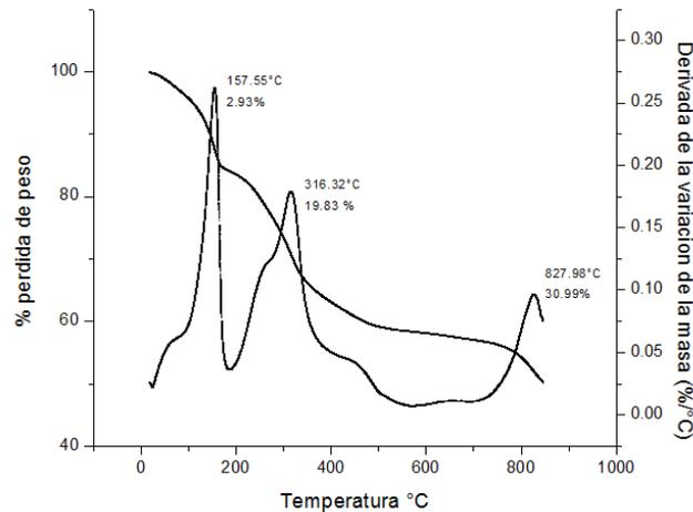
Figura 3.7. Análisis termogravimétrico de HTMgFe
