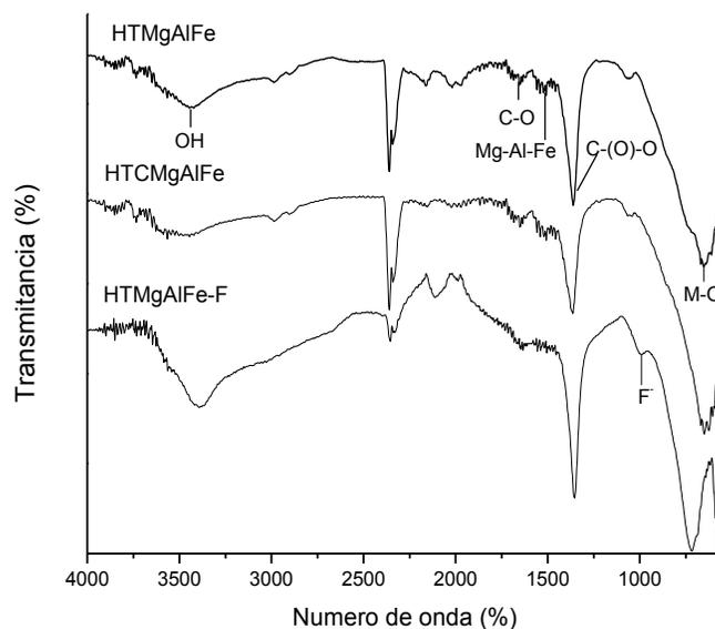
Figura 3.6. Espectro IR de las hidrotalcitas MgAlFe
