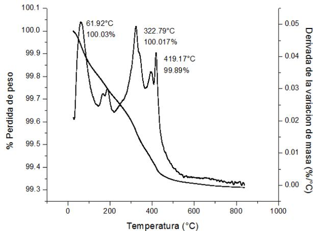
Figura 3.8. Análisis termogravimétrico de HTCMgFe
