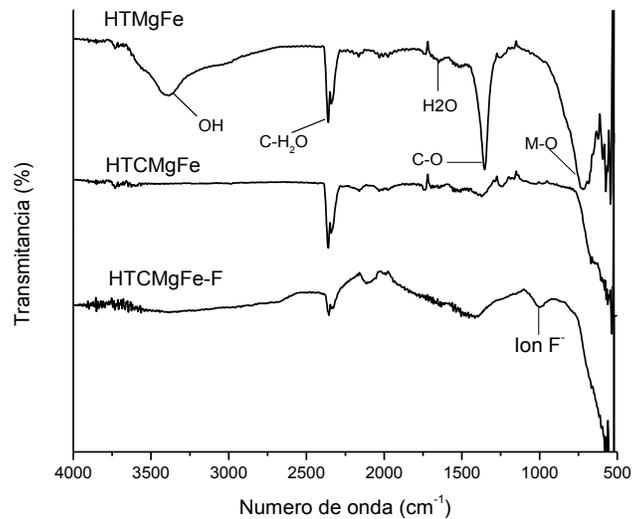
Figura 3.5. Espectro IR de las hidrotalcitas MgFe
