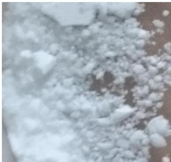
Fig. 3.4 MCM-41 sintetizado por el método de Yin [62].
