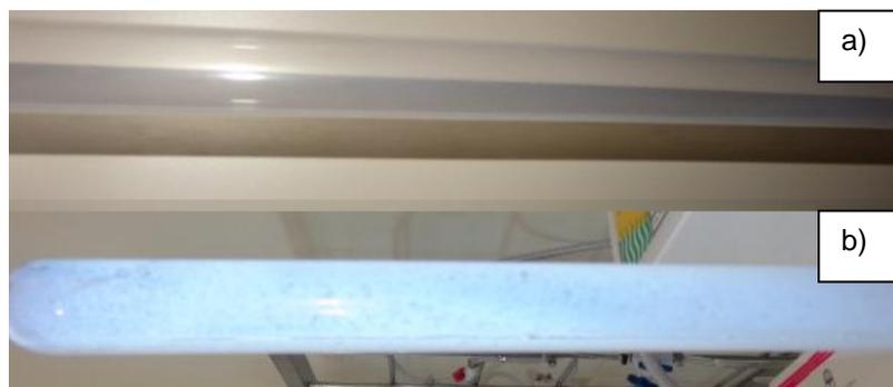
Figura 3. 13 Recubrimiento de la lámpara por  $\text{TiO}_2$ .
