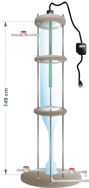
Figura 2. 2 Esquema del reactor y estructura de soporte diseñados e instalados.
