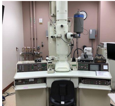
Figura 3.8 Microscopio electrónico de transmisión modelo JEOL JEM-2010.
