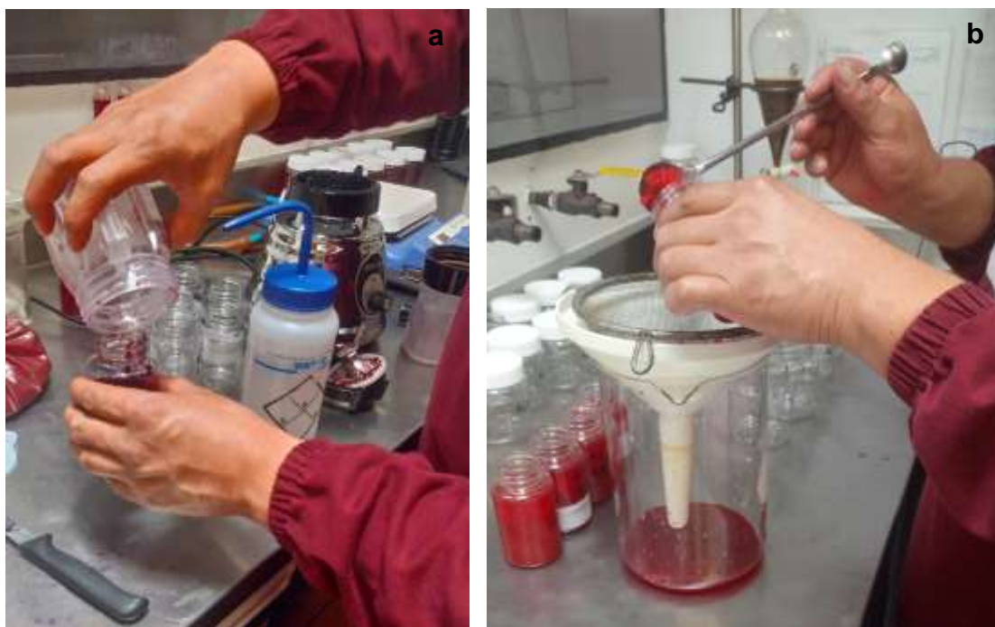
Figura 2.20 Proceso de extracción del pigmento de la zanahoria morada: (a) primera extracción del pigmento y reposo del primer macerado y (b) segunda extracción de las misma muestra y separación del sobrenadante después del tiempo de maceración.
