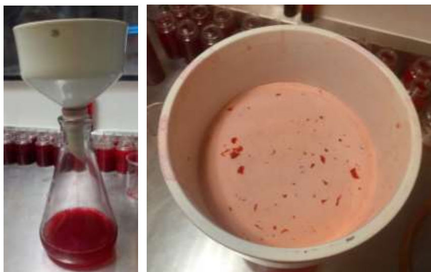
Figura 2.21 Clarificación de los extractos de zanahoria morada mediante filtración a vacío con tierra Diatomea.
