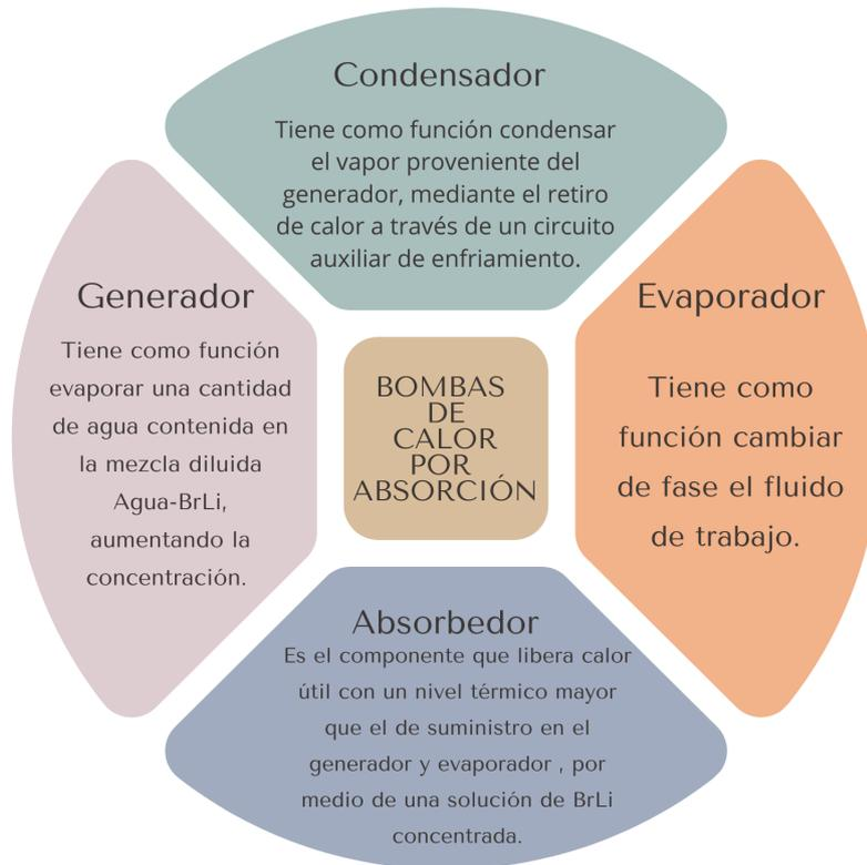
Figura 2.4: Funciones de los componentes de las bombas de calor por absorción.
