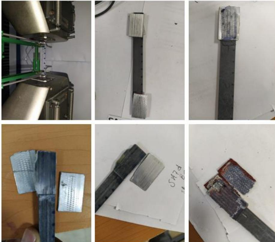
Figura 47. Pruebas de diversos talones para mejorar la sujeción.
