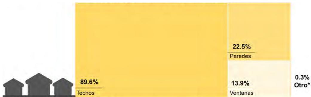
Figura 1.4: Uso de material aislante por componente de edificación en la región cálida extrema.
