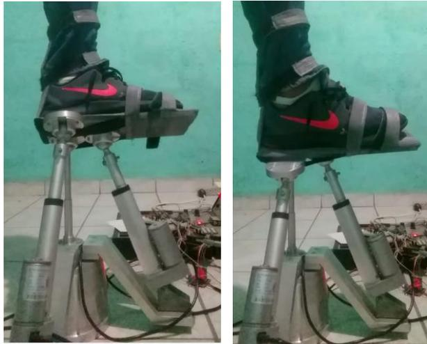
Figura. 4.45. Dispositivo en posición Supinación/Pronación a  $20^\circ$  y  $-20^\circ$ .
