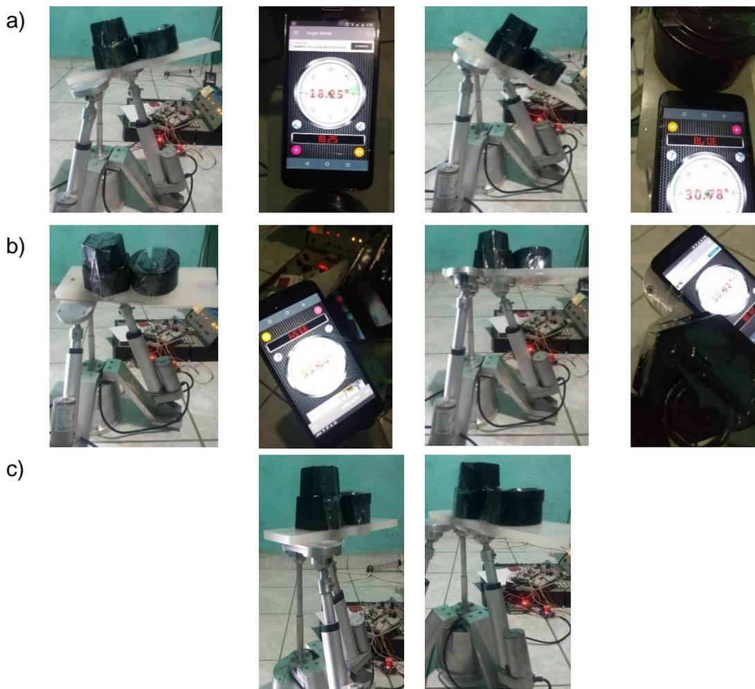
Figura. 4.42. Movimientos a diferentes amplitudes, rangos a) Flexión/Extensión  $18^{\circ}$  a  $-30^{\circ}$ , b) Supinación/Pronación  $30^{\circ}$  a  $-30^{\circ}$  y c) Aducción/Abducción  $45^{\circ}$  a  $-45^{\circ}$ .
