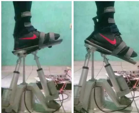
Figura. 4.44. Dispositivo en posición Flexión/Extensión a  $18^{\circ}$  y  $-30^{\circ}$  respectivamente.
