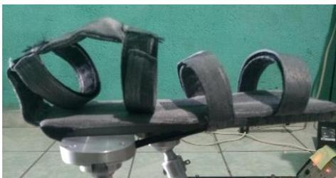
Figura G-2. Dispositivo de sujeción del tobillo.
