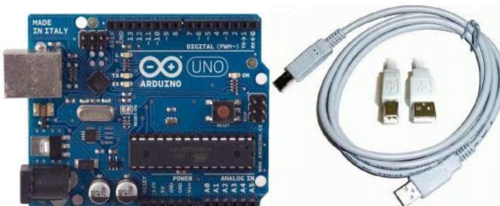
Figura A-1. Placa de Arduino y cable de conexión.
