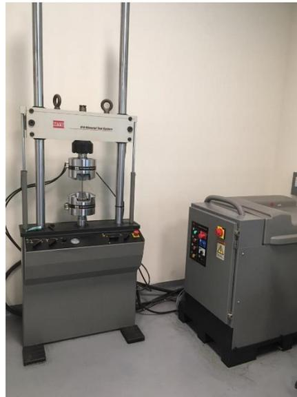
Figura 22: Máquina de ensayos universal MTS 810
