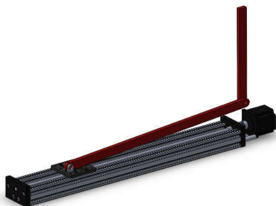
Figura 5.12 Base de muslo y pierna con ejes como guías y soporte.
