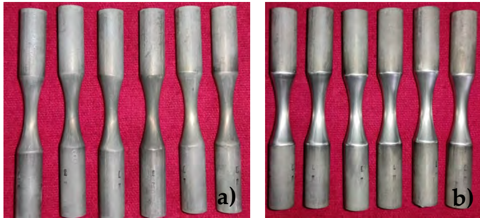
Figura 32 Muestras después de los tratamientos térmicos. a) Óxido provocado por los tratamientos térmicos y b) Óxido retirado con lija de grano 3000.
