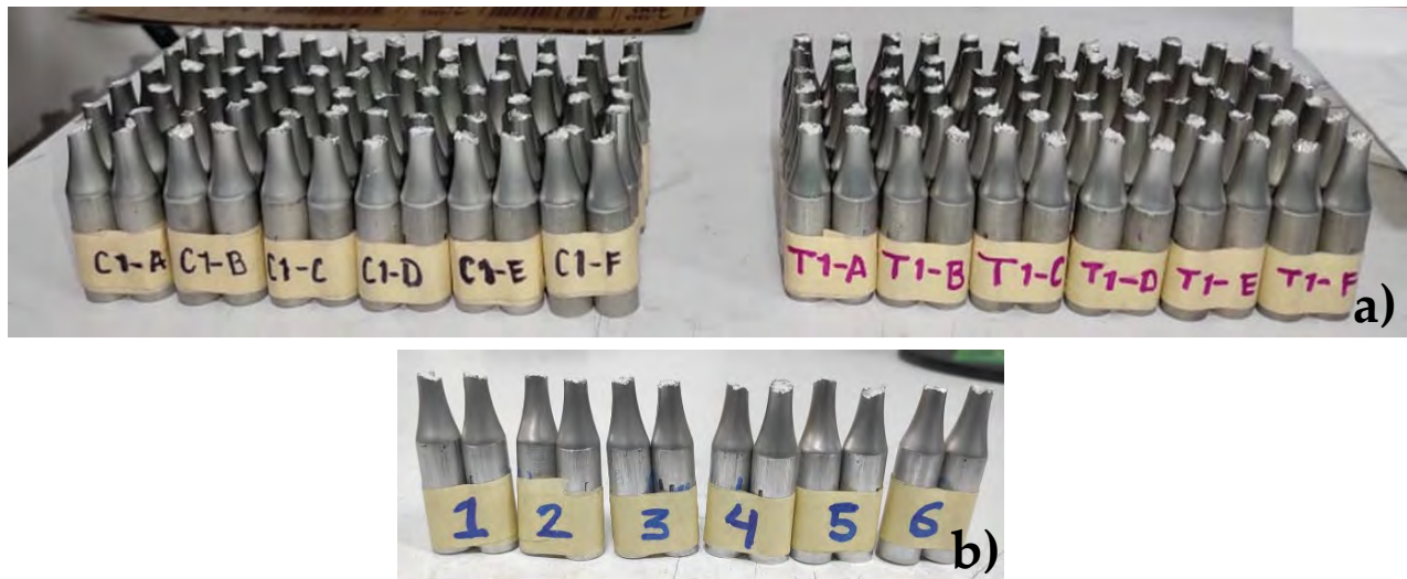
Figura 35 Probetas ensayadas hasta la fractura. a) Con tratamiento térmico y b) En condición de llegada.
