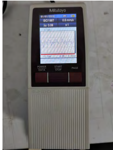
Figura 33 Rugosímetro portátil para la medición de rugosidad de seis muestras lijadas.
