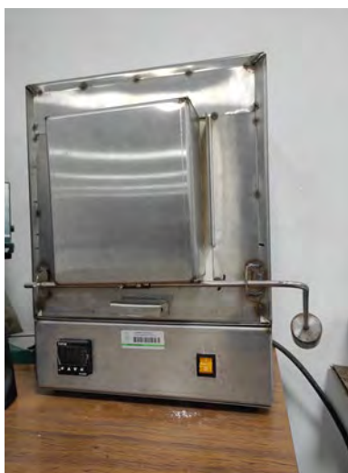
Figura 31 Mufla utilizada para los tratamientos térmicos.
