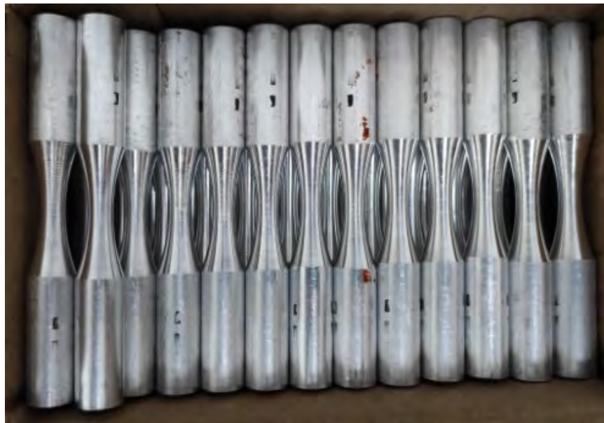
Figura 30 Probetas de Al6061-T6 maquinadas y limpias de impurezas superficiales.
