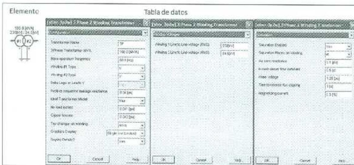
Figura 5.3. Modelado del Transformador empleando PSCAD/EMTDC
