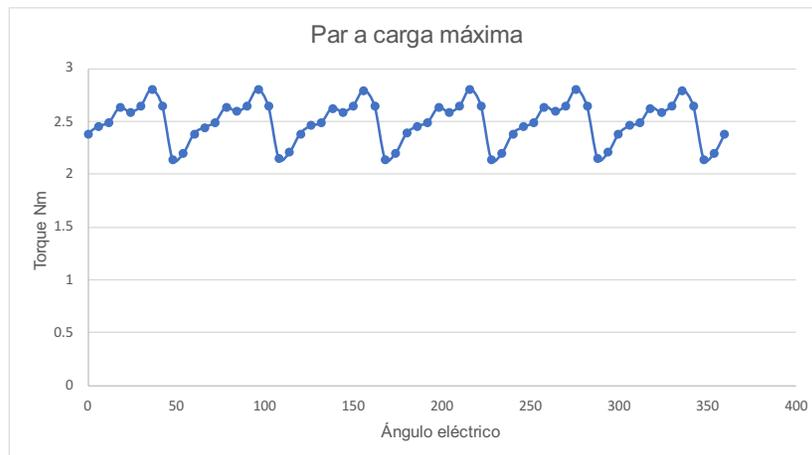
Fig. 47. Torque del motor de doble rotor a carga máxima
