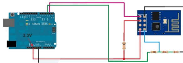
Figura 2. 8.- Conexión entre Arduino y la tarjeta ESP-01.
