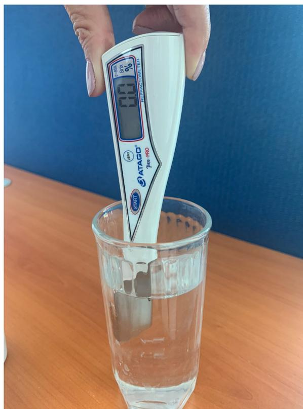
Figura 4.7: Calibración realizada refractómetro PEN-PRO.
