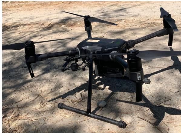
Figura 2.2: VANT utilizado para captura de imágenes.
