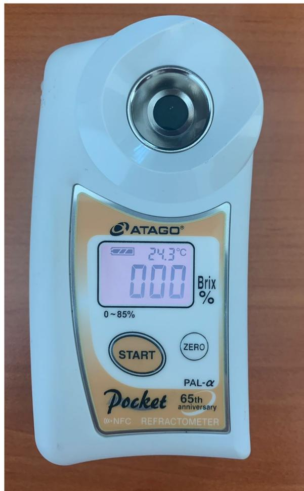
Figura 4.8: Calibración realizada refractómetro Pocket.
