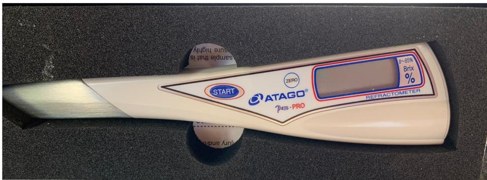
Figura 4.2: Refractómetro PEN-PRO
