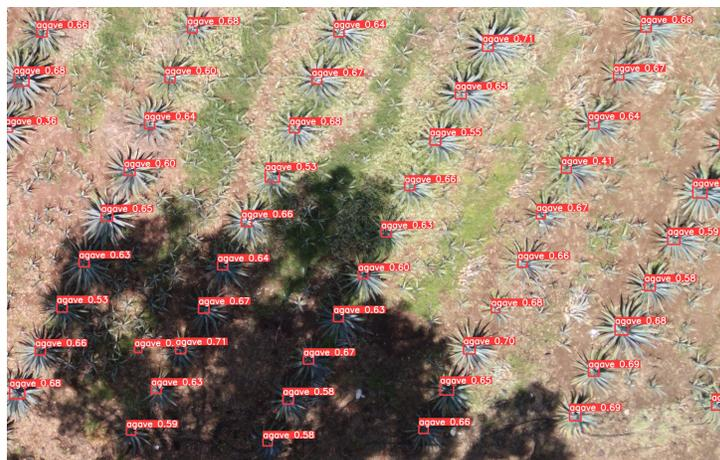
Figura 4.14: Detección y conteo de plantas de agave con sombras y maleza usando YOLOv5.
