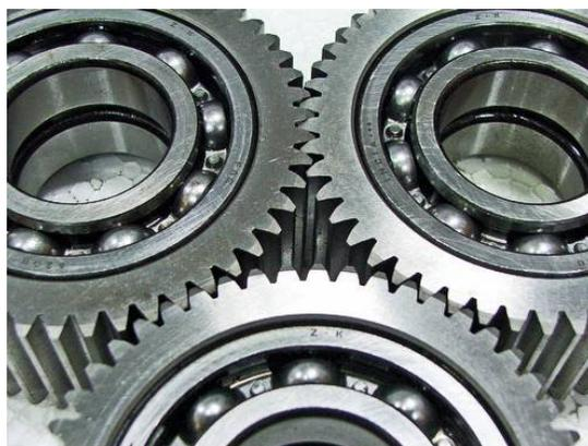
**Figura 2.6 Los engranes que interactúan en muchos de los sistemas están constantemente sometidos a cargas cíclicas que terminan por desgastarlos.**
