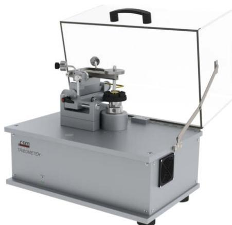
**Figura 3.7** Tribómetro CSM Instruments empleado para los ensayos de fricción.
