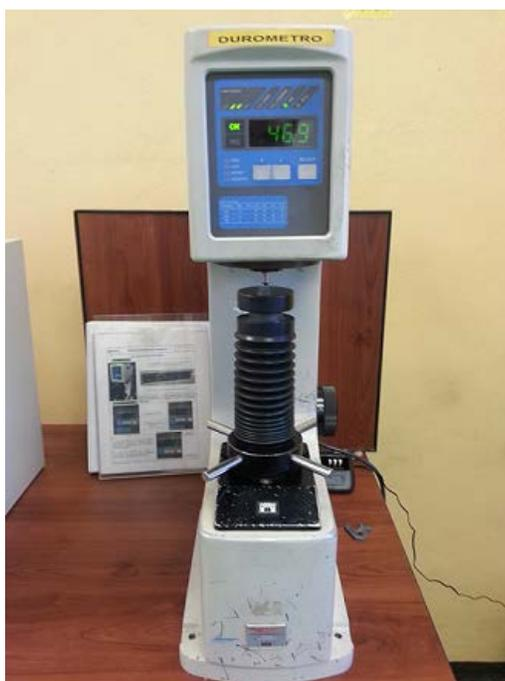
**Figura 3.4 Durómetro empleado para determinar la dureza de los sustratos.**
