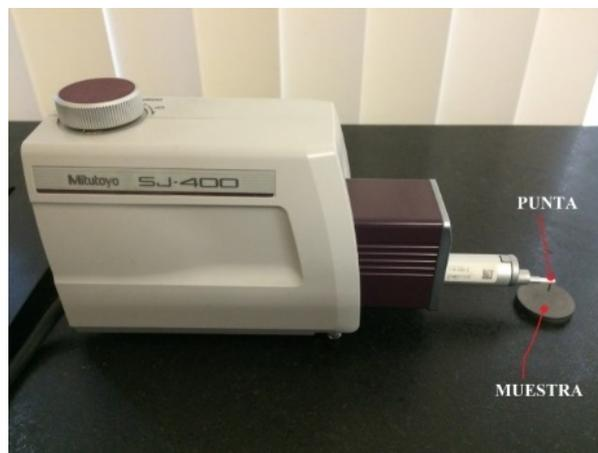
**Figura 3.5 Rugosímetro empleado para la determinación de la rugosidad promedio de probetas.**
