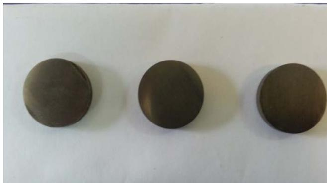
**Figura 3.3 Sustratos de acero D2 y M4 cortados por electroerosión.**
