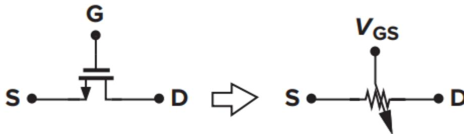
**Figura 3. 1:** MOSFET como un resistor lineal controlado por voltaje.
