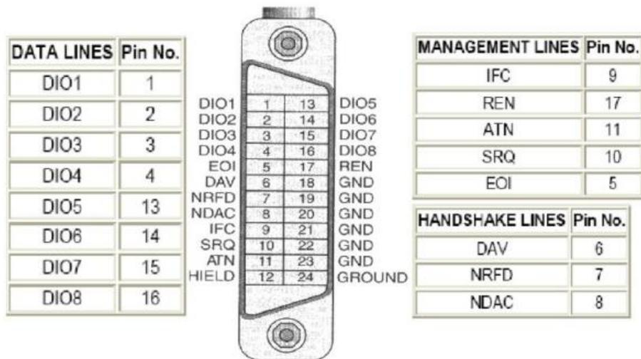
**Figura 2. 23:** Conector estándar de acceso al bus GPIB y asignación de señales [14].
