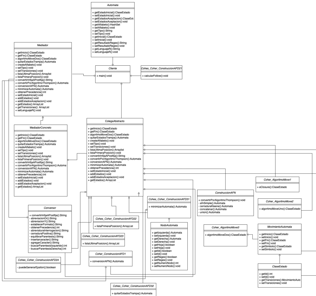
Figura 33. Arquitectura de clases de la aplicación ConversionAutomata después de la re-factorización.
