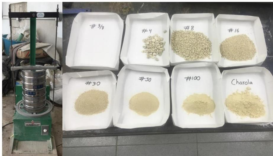
*Fig. 3.4. Prueba de granulometría del agregado fino.*
