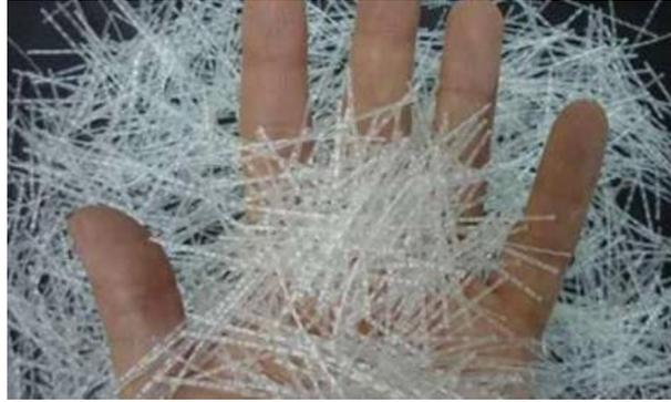
*Fig. 1.3. Fibras de polipropileno.*
