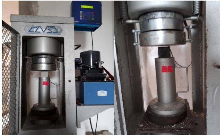
Fig. 4.6. Prueba de compresión de las muestras.
