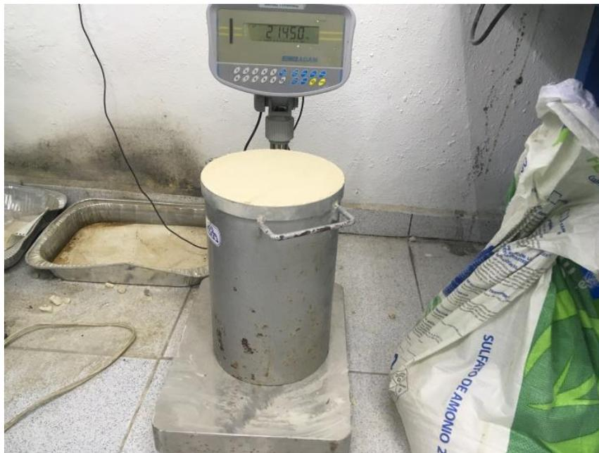
*Fig. 3.7. Prueba de peso volumétrico seco y suelto del agregado fino.*
