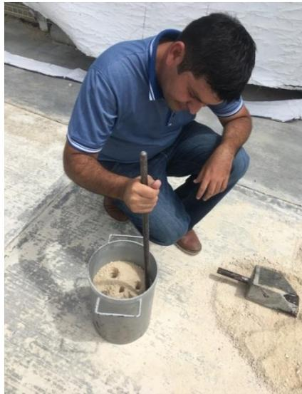
Fig. 3.8. Prueba de peso volumétrico seco y compacto del agregado fino.
