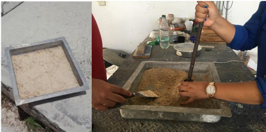
*Fig. 3.9. Prueba de porcentaje de absorción del agregado fino.*
