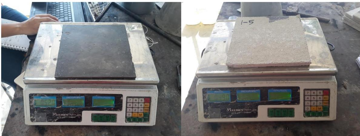
Fig. 4.1. Prueba de densidad de las muestras.
