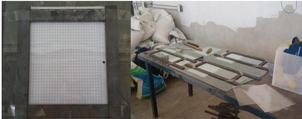
*Fig. 3.11. Fabricación de moldes para las muestras.*
