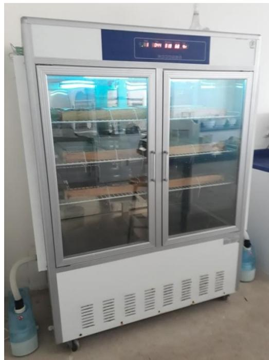
Fig. 4.16. Cámara climática (prueba de temperatura, humedad relativa, intensidad de luz de las muestras).
