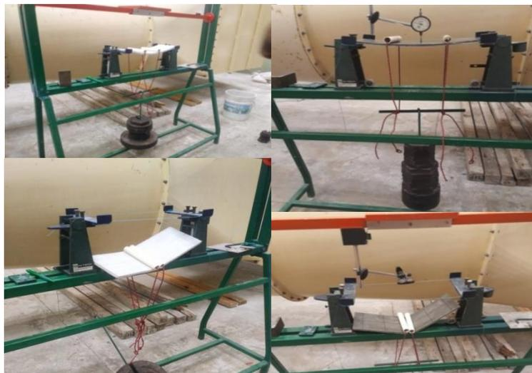
*Fig. 4.8. Prueba de flexión de las muestras.*
