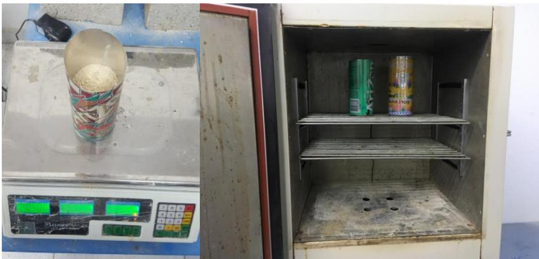
*Fig. 3.10. Prueba de humedad del agregado fino.*
