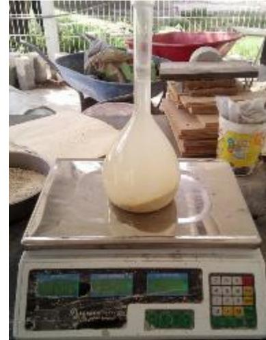
Figura 3.12 Pesaje del matraz aforado
