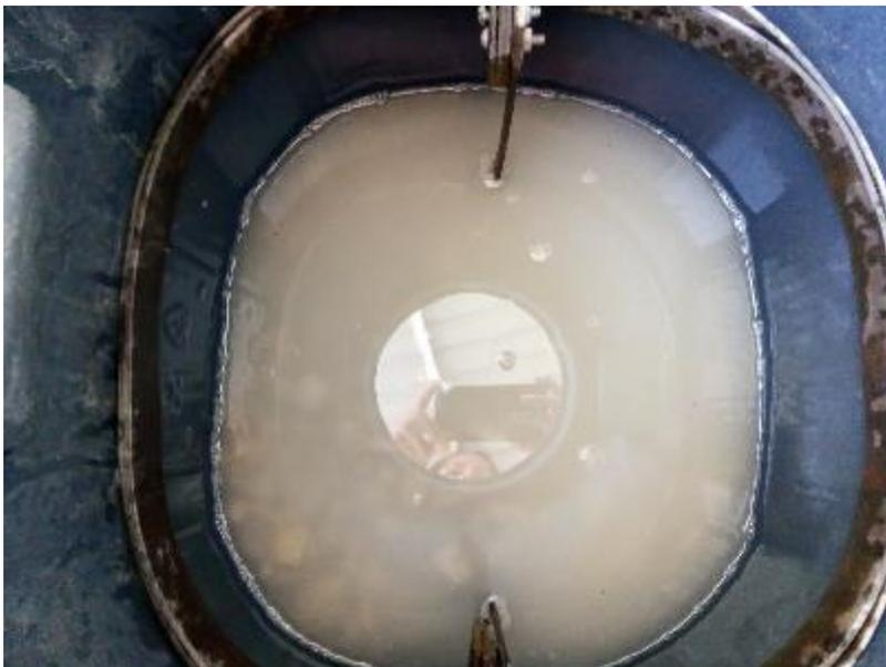
Figura 3.24 Agregado grueso cubierto por solución de Silicato de sodio en cámara al vacío
