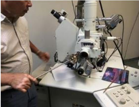
**Figura 3.57 Colocación de las muestras en el Microscopio**
