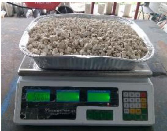
Figura 3.16 Pesaje de agregado grueso seco.
