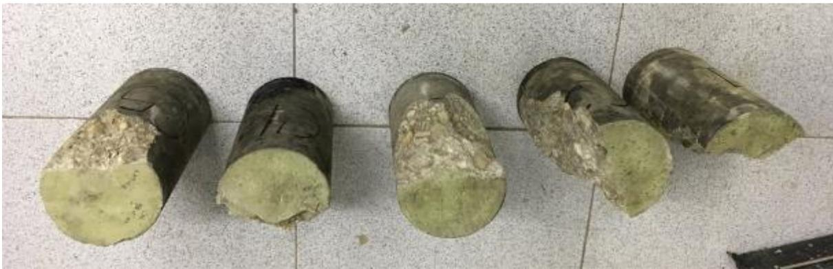
**Figura 3.45 Cilindros experimentales sometidos a prueba de compresión**
