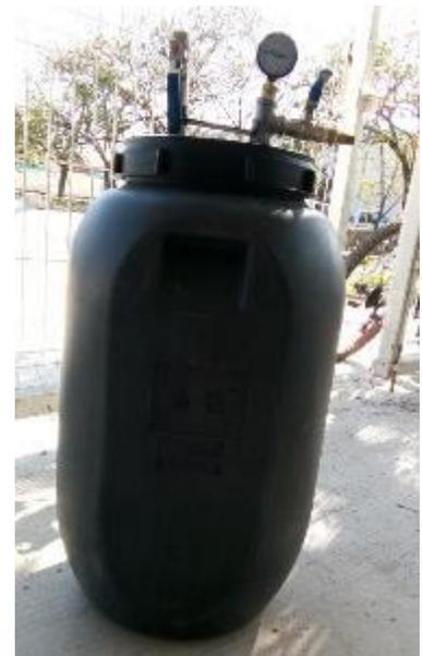
Figura 3.25 Cámara de impregnación al vacío con tres
