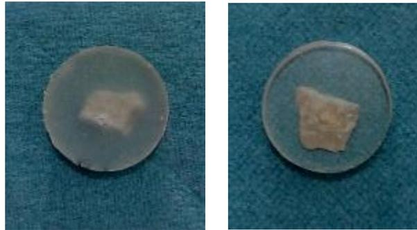
**Figura 3.51** Desbaste con lijas de agua de las muestras en resina
