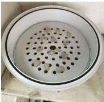
Figura 3.55 Desecador de silica con muestras preparadas
