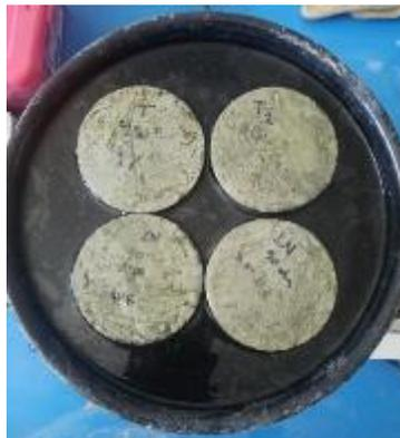
**Figura 3.48** Cilindros sumergidos en agua hirviendo
