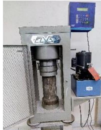
Figura 3.43 Prueba de compresión en cilindros de 30 cms
