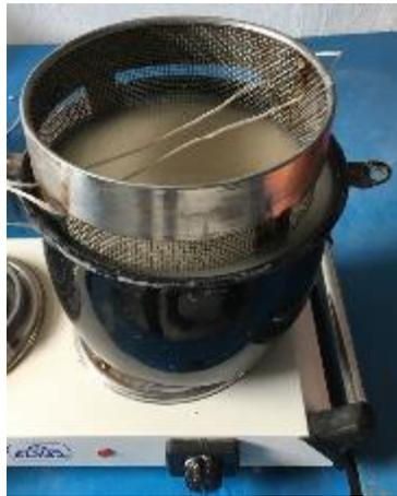
**Figura 3.29** Inmersión del agregado grueso en solución de PVA
