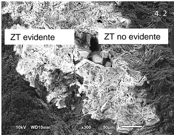
En la imagen 4.2 se observa un grano de grava rodeado de pasta cementante, del lado derecho no se distingue la Zona de Transición (ZT), por lo que se presume que la adherencia obtenida es por el PVA que recubrió ése lado del agregado, mientras de que del lado izquierdo si se aprecia una separación (ZT) entre el agregado y la pasta
