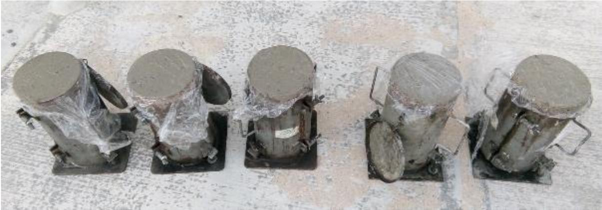
Figura 3.37 Cilindros de concreto experimental de 30 cms.
