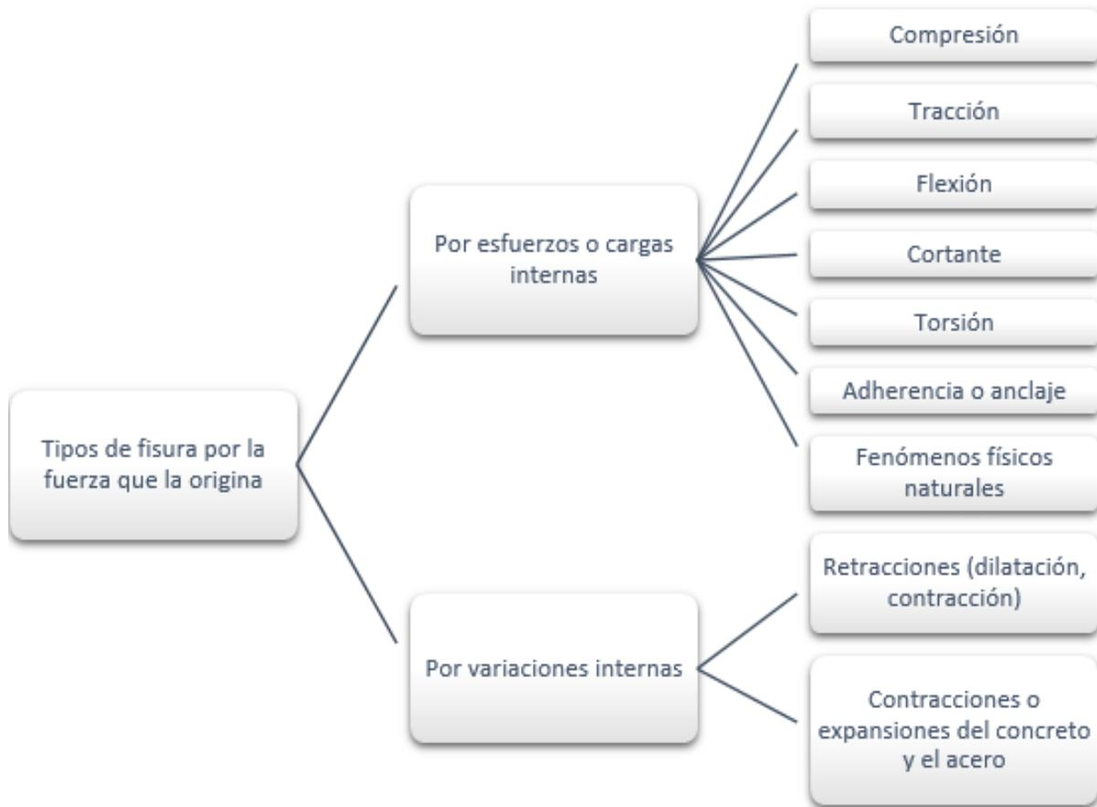
Figura 1.1 Causas posibles de la fisuración (IMCYC, 2002)
