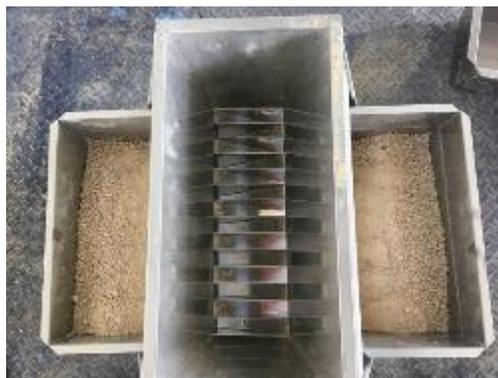
Figura 3.10 Cribado del agregado fino
