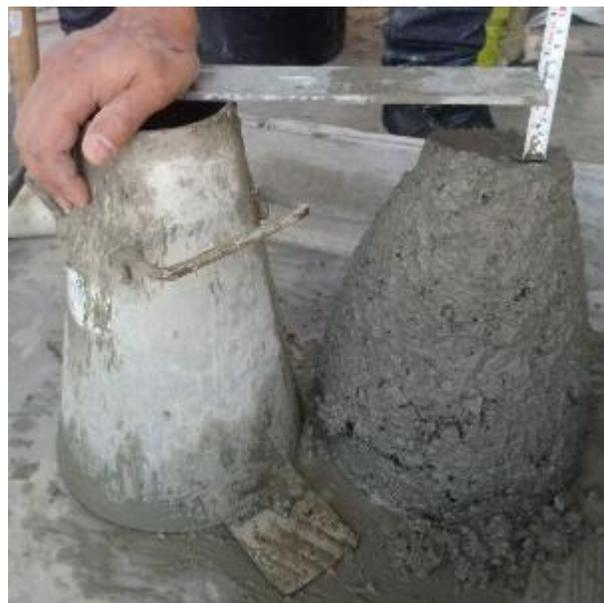
**Figura 3.34 Prueba de revenimiento en concreto de control**
