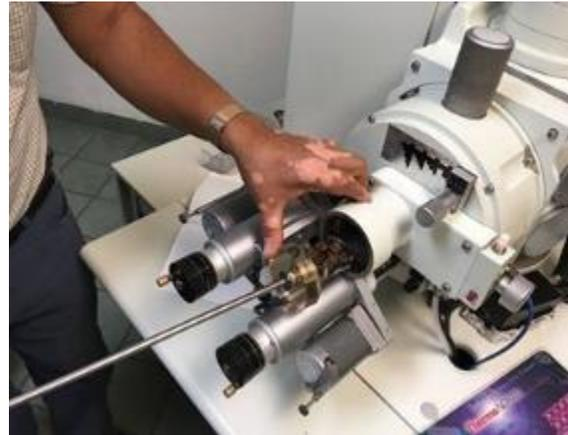
**Figura 3.58 Preparación de muestras en el MEB para hacer el vacío**
