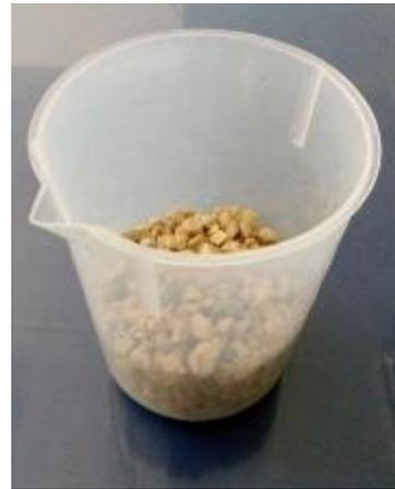
**Figura 3.30** Muestra de agregado grueso encapsulado con PVA
