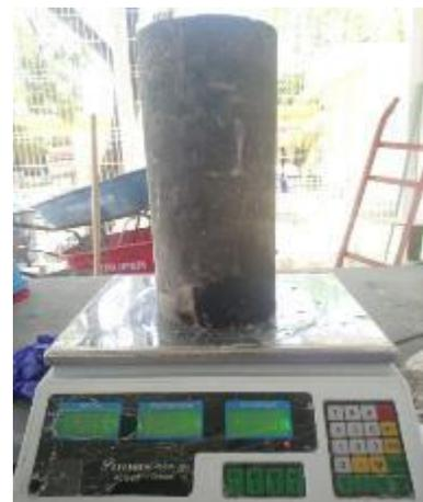
Figura 3.42 Pesaje de cilindros
