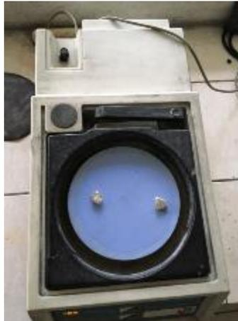
Figura 3.52 Pulidora rotatoria
