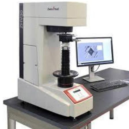
Figura 3.53 Indentador Vickers para prueba de dureza
