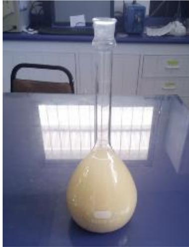
Figura 3.11 Matraz aforado con agua y agregado fino
