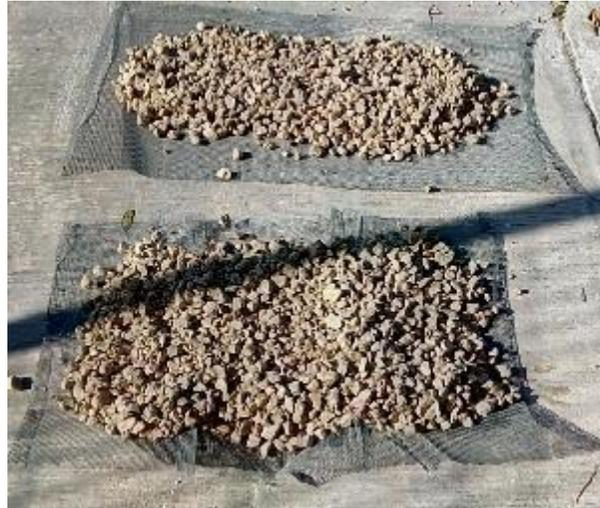
**Figura 3.26 Agregado grueso saturado con solución de silicato de sodio**
