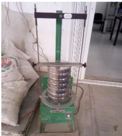
Figura 3.8 Cribado del agregado fino
