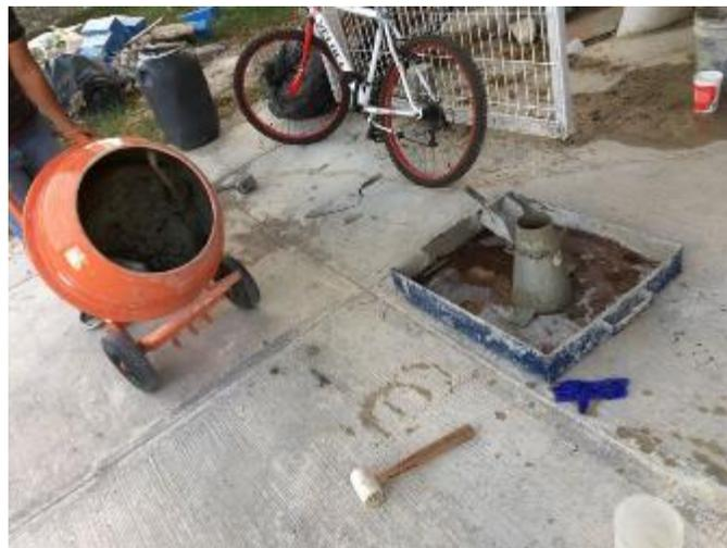
**Figura 3.32 Prueba de asentamiento plástico en concreto fresco**
