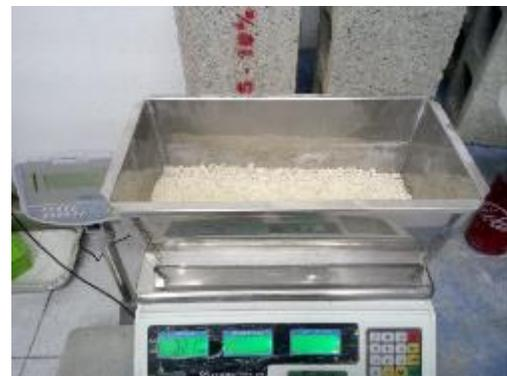
Figura 3.7 Pesaje del agregado fino
