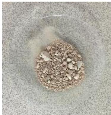
Figura 3.13 Agregado fino seco en cristal de reloj.
