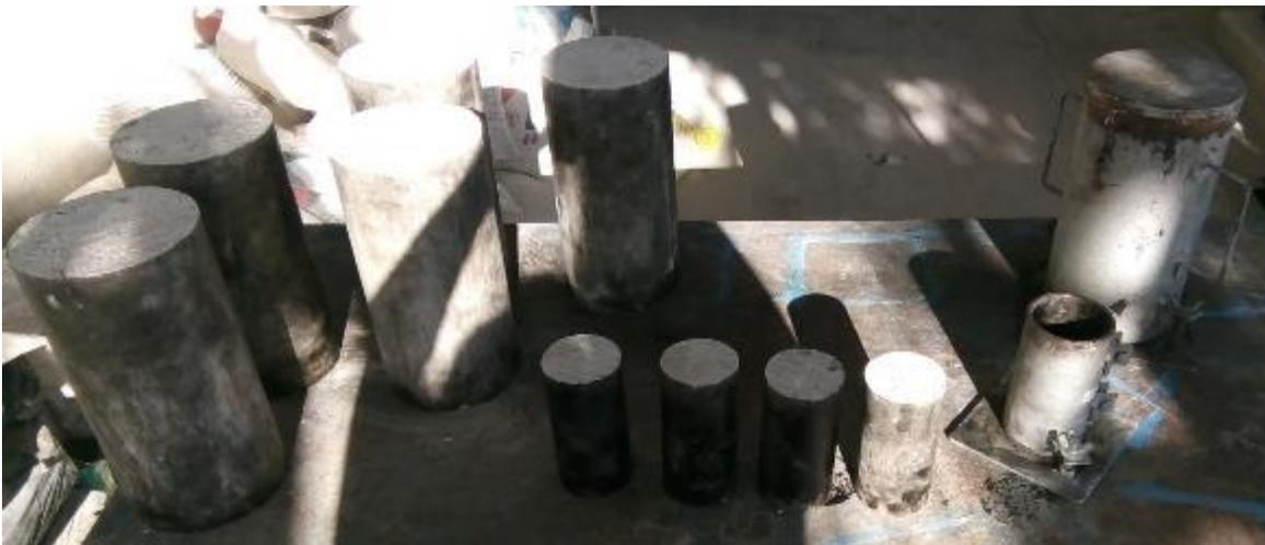
**Figura 3.41 Cilindros de concreto de control de 30 y 15 cms.**
