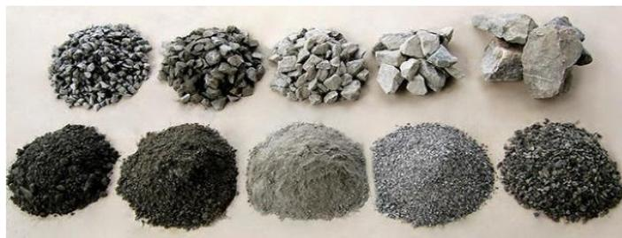
Figura 1.3 Diferentes tipos de agregados
