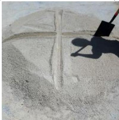
**Figura 3.5 Cuarteo del agregado fino**
