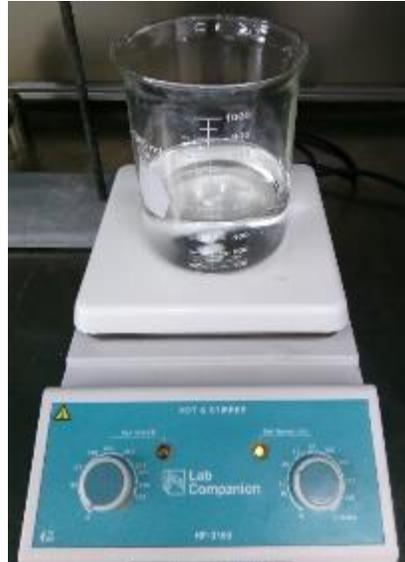
Figura 3.21 Mezcla de la solución con agitador magnético
