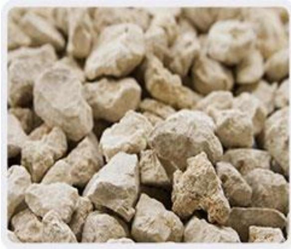
Figura 1.5 Agregado calizo
