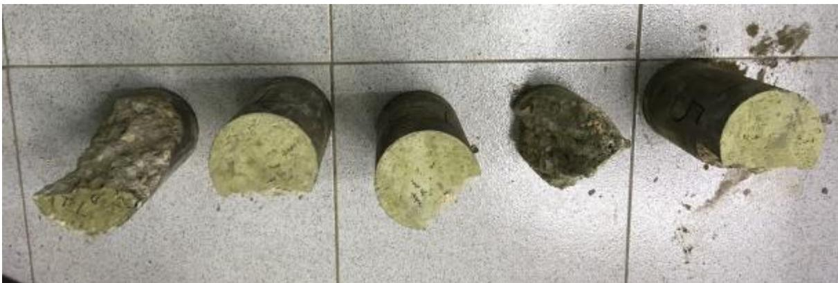
**Figura 3.46 Cilindros de control sometidos a la prueba de compresión**
