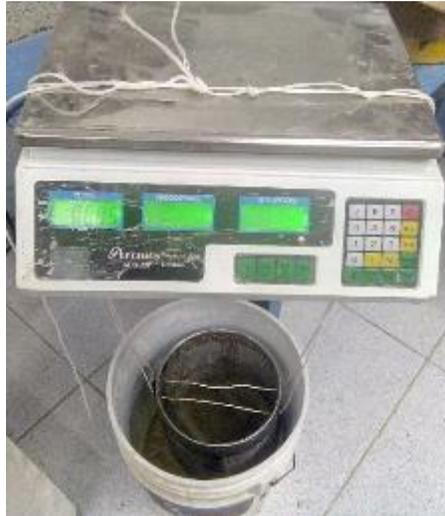
**Figura 3.49** Pesaje de cilindros sumergidos
