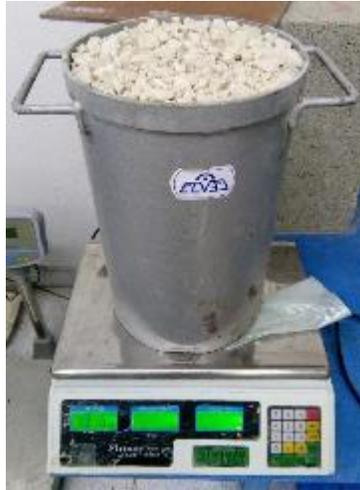
**Figura 3.15** Peso del agregado grueso
