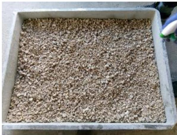
Figura 3.28 Agregado recubierto con PVA
