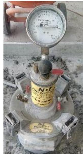
Figura 3.36 Lectura del contenido de aire en concreto fresco
