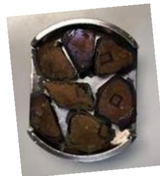
Figura 3.56 Muestras metalizadas con cobre para el MEB
