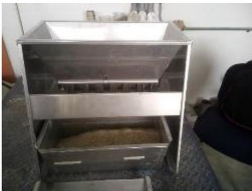
Figura 3.6 Cuarteo del agregado fino
