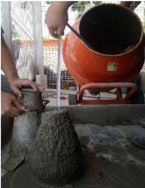
**Figura 3.33 Lectura de revenimiento en concreto experimental**
