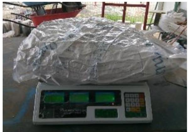
Figura 3.17 Resguardo al vacío del agregado grueso seco
