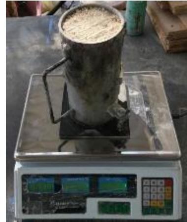
**Figura 3.14** Determinación de peso suelto del agregado fino
