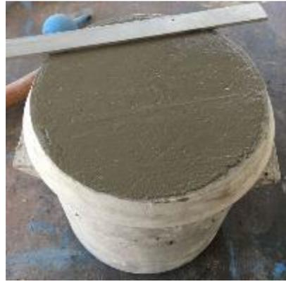
Figura 3.35 Determinación del rendimiento del concreto fresco
