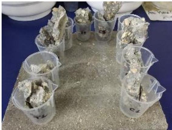
Figura 3.50 Recuperación de muestras de cilindros tronados.
