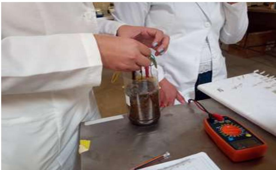
**Figura 16:** Representación de la toma de voltaje de las CCM de Zarzamora.
