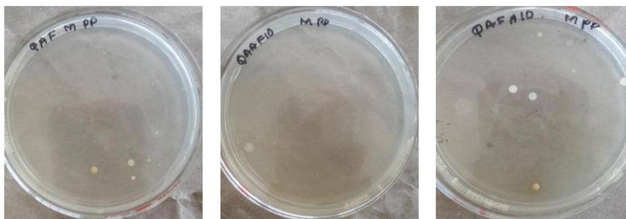
**Figura 3.3 Prueba de contaminación previa con agar para método estándar.**
