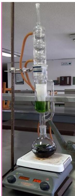
**Figura 2.1** Dispositivo de extracción Soxhlet.
