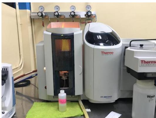
Figura 7. Lectura de muestras en espectrofotómetro de absorción atómica.
