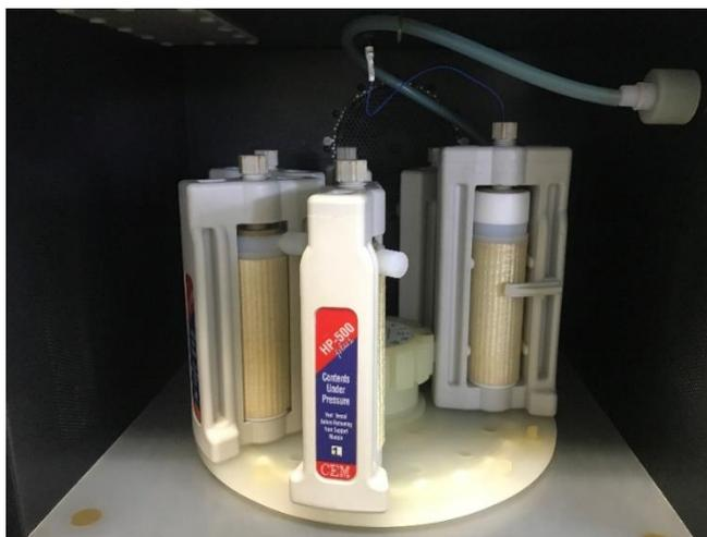
Figura 5 . Vasos de digestión colocados sobre el rotor del microondas de digestión.
