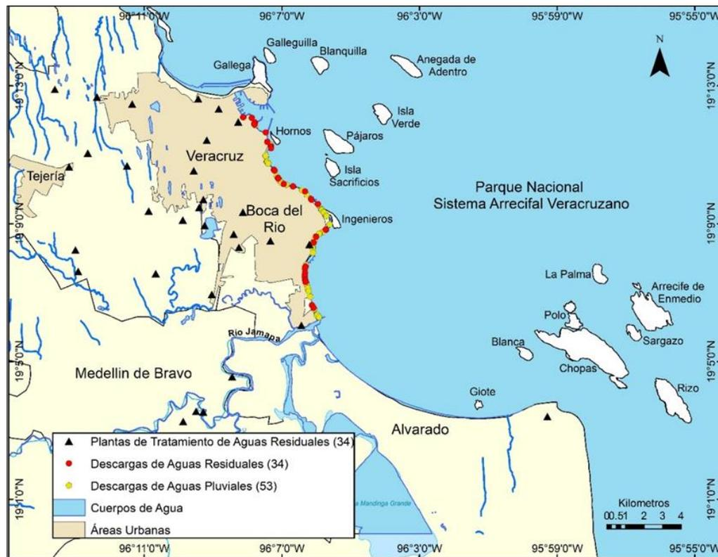
Figura 8. Puntos de descarga de aguas residuales y pluviales en Veracruz-Boca del Río. (Tomado de INEGI, 2016. Escala 1:50000).
