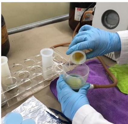
Figura 6. Filtración de muestras en bomba de vacío.
