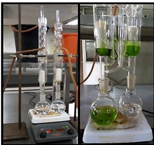
**Figura 2.1.** Dispositivo de extracción Soxhlet
