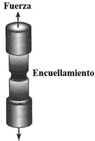
**Figura 2.8.** Deformación localizada durante el ensayo de tensión de un material dúctil produciendo una región de encuellamiento [51]
