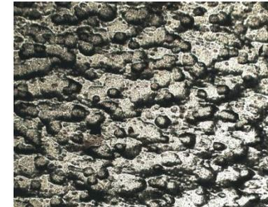
**Figura 3.33.** Comparación de las microfotografías de las películas elaboradas con ácido acético antes y después de la prueba de intemperismo
