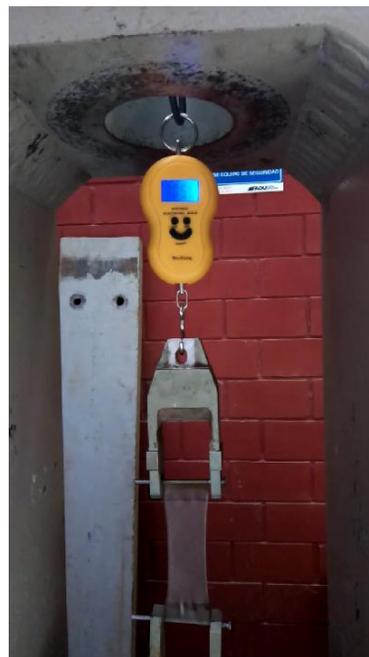
**Figura 2.9.** Ejemplo de la realización de la prueba de tensión a una de las películas
