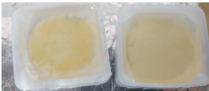
Figura 4 Formación de películas por vía casting
