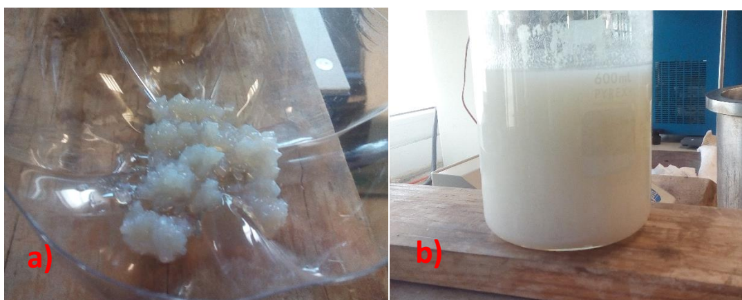
Figura 2.4.2.3. a) hojuelas de PET, con disminución de tamaño, b) etilenglicol y PET, de la primera etapa de reacción.
