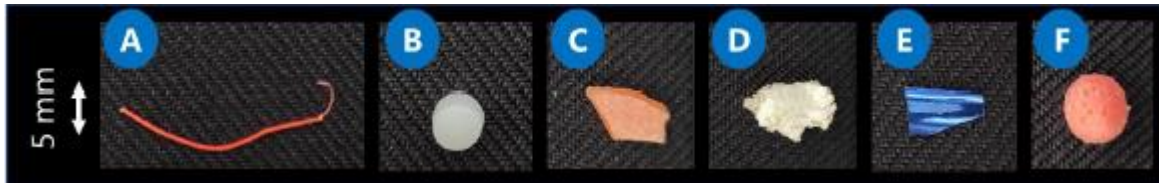
Figura 5. Tipos de microplásticos: a) fibras, b) pellets, c) fragmentos rígidos, d) espumas, e) películas y f) balines
