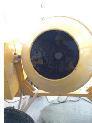
b) Mezclado de concreto en revolvedora
