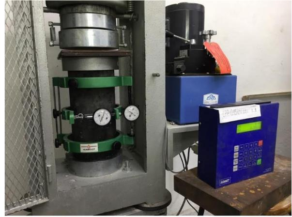
b) Colocación de cilindro en prensa mecánica
