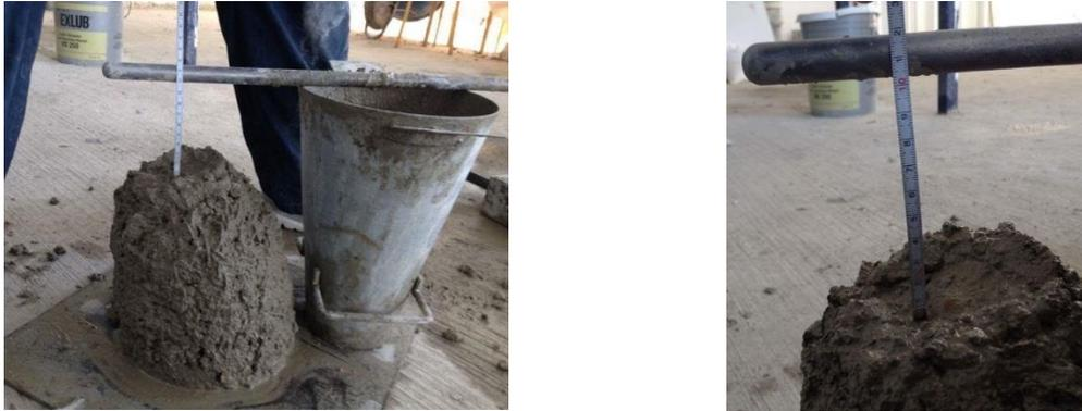
**Figura 33.** Ensayo de revenimiento.
