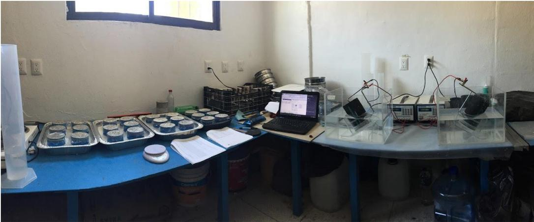
**Figura 41.** Ensayos NTBuild 492 y absorción capilar realizados simultáneamente.
