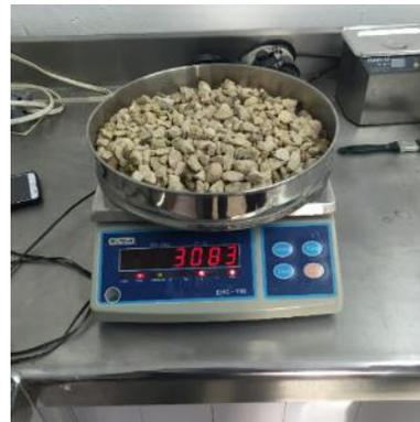
b) Determinación del peso del agregado SSS.
