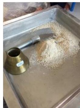
**Figura 21.** Agregado fino en estado saturado superficialmente seco SSS.
