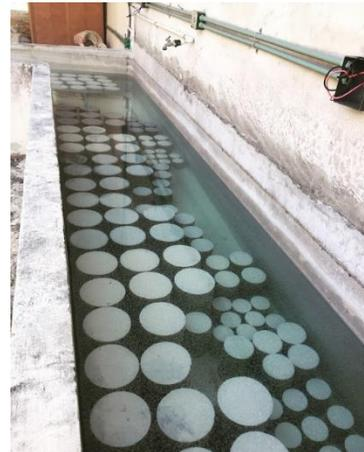
Desmolde de cilindro 24h después de colado    Curado en pileta a temperatura ambiente
