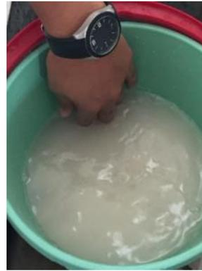
**Figura 15.** Saturación de agregado grueso 24 horas.
