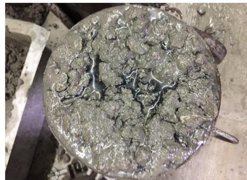
**Figura 60.** Aglomeración NTCM en concreto estado fresco.
