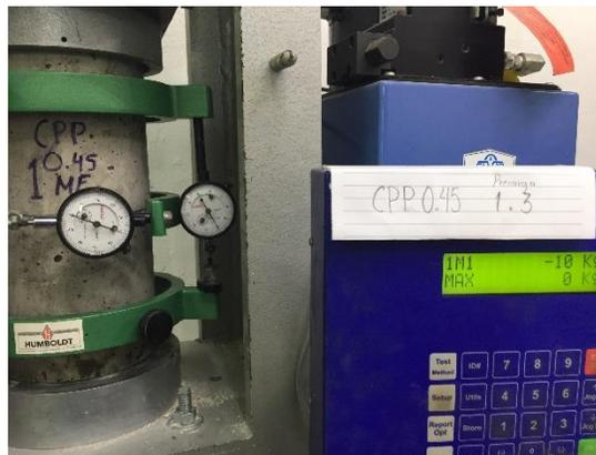
c) Aplicación de carga al 40% en base a carga de ruptura
