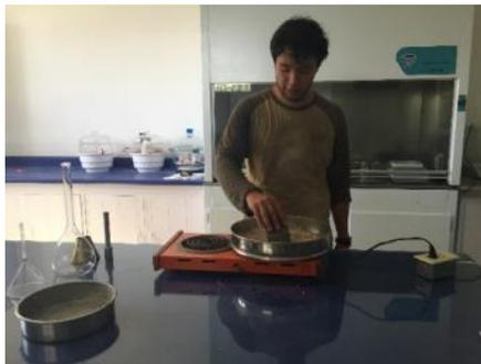
**Figura 20.** Prueba provisional de molde de cono, 25 golpes con pinzón.
