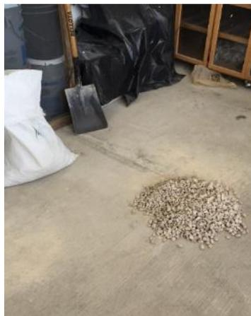
**Figura 14.** Reducción de la muestra por cuarteo.
