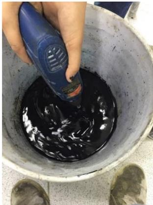
**Figura 32.** Dispersión por medios mecánicos de NTC con agua de mezclado.
