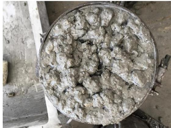
**Figura 33.** Concreto en estado fresco adicionado con NTCM, CPC0.45NTC.
