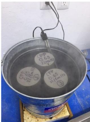
a) Probetas sumergidas en agua hirviendo
