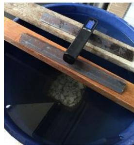
**Figura 17.** Determinación del peso del agregado en estado sumergido.
