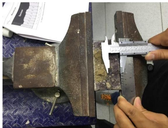
b) Medición de penetración con Vernier
