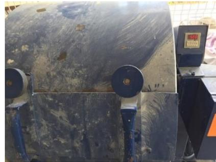
d) Ensayo hasta 500 revoluciones
