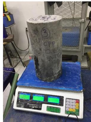
b) Determinación de masa del espécimen CPP 0.65 NTC
