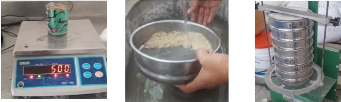
**Figura 13.** Proceso de lavado y tamizado de la arena.
