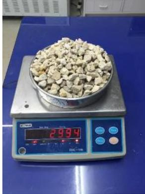
**Figura 18.** Determinación del peso del agregado después de seco en horno a 110°C durante 24h.
