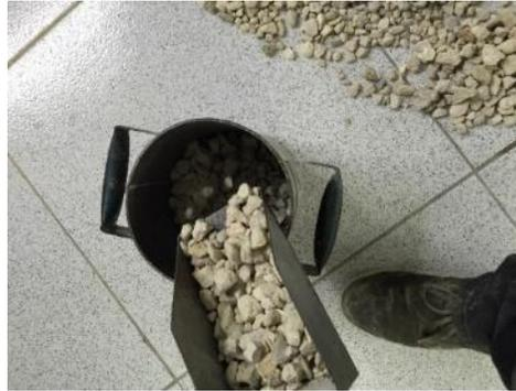
**Figura 26.** Peso volumétrico suelto grava.
