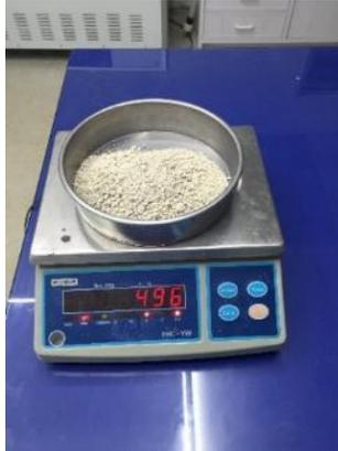
**Figura 24.** Peso seco de la muestra después de horno 110°C por 24h.
