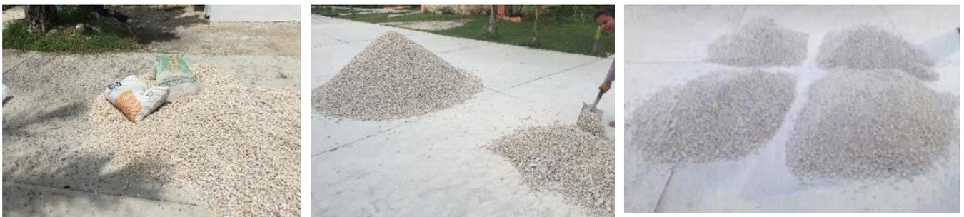
**Figura 10.** Cuarteo general de agregados.
