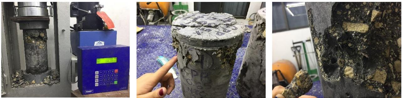
**Figura 68.** Ensayo de resistencia a la compresión en concretos con adición NTCM.
