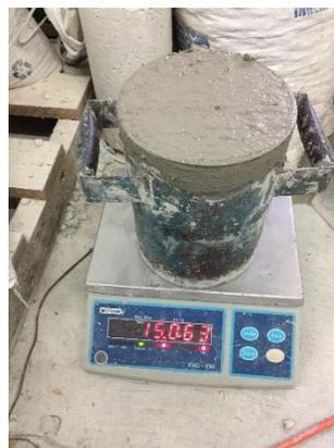
**Figura 34.** Ensayo peso volumétrico del concreto.
