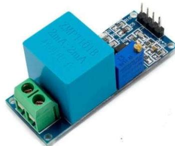
Figura 2.2. Sensor analógico de voltaje. [5]
