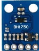
Figura 2.7. Sensor de iluminación digital BH1750. [11]
