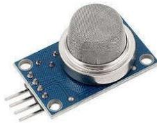
Figura 2.5. Sensor de presencia de gas MQ-2. [9]
