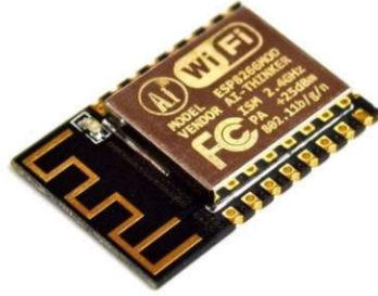
Figura 1.8. Circuito integrado ESP8266. [17]
