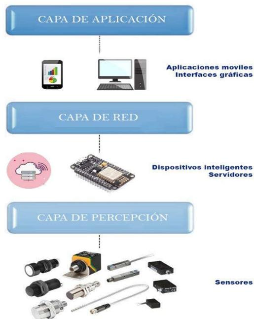
Figura 2.10. Arquitectura de tres capas de una red *IoT*.
