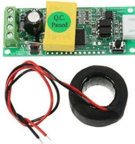
Figura 2.3. Sensor con salida a protocolo de comunicación digital PZEM-004T. [7]
