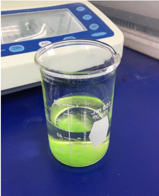
**Figura 3.3** Mezcla obtenida de la Sal Precursora Cloruro de Niquel con el 1-Butanol. Previo a la mezcla.
