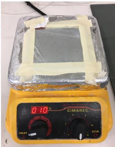
**Figura 3.26** Vidrio con ITO colocado en plancha a 30°C
