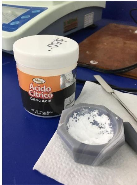
**Figura 3.5** Ácido Cítrico molido mecánicamente en mortero de ágata
