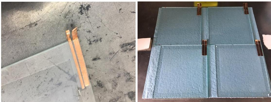
**Figura 3.22** Vidrios con depósito de ITO con cobre ya instalado
