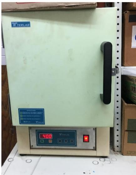
**Figura 3.8** Mufla Terlab con NiO calcinado a 400°C
