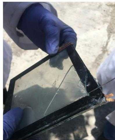
**Figura 3.31** Aplicación de Litio en el centro del dispositivo
