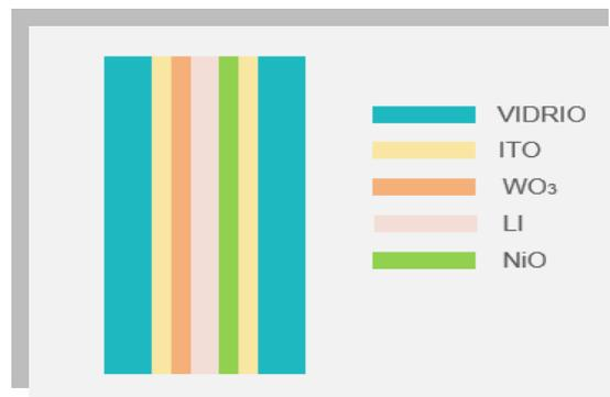
**Figura 3.29** Distribución de los componentes en el dispositivo electrocrómico a elaborar
