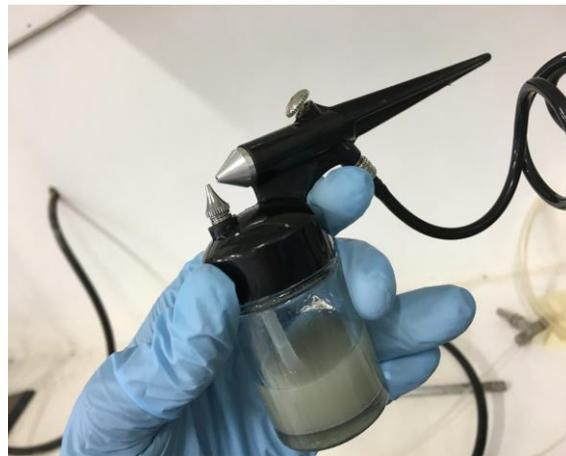
**Figura 3.25** NiO con alcohol en aerógrafo para realizar el depósito
