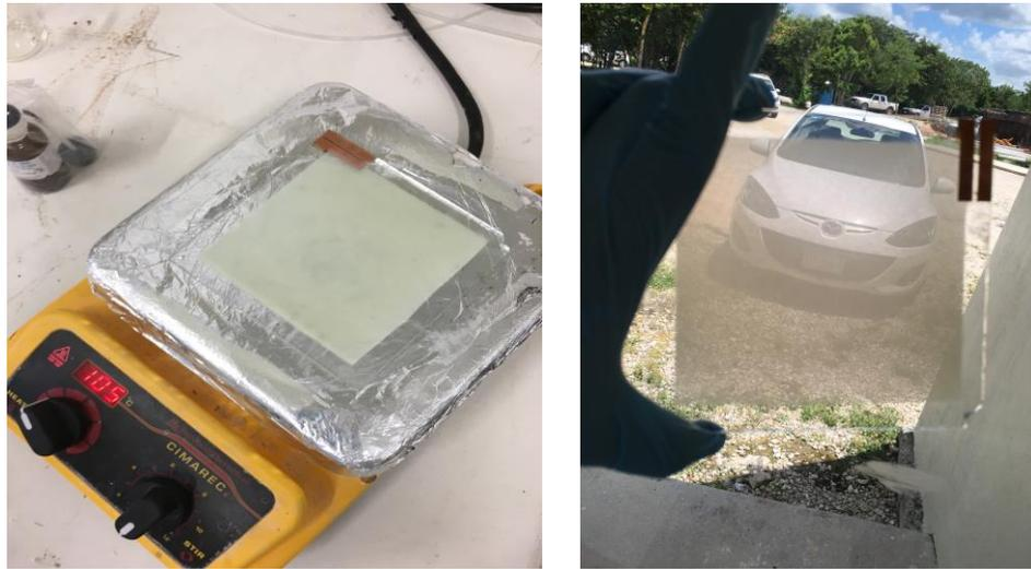
**Figura 3.28** Proceso finalizado de vidrio depositado con ITO y Níquel
