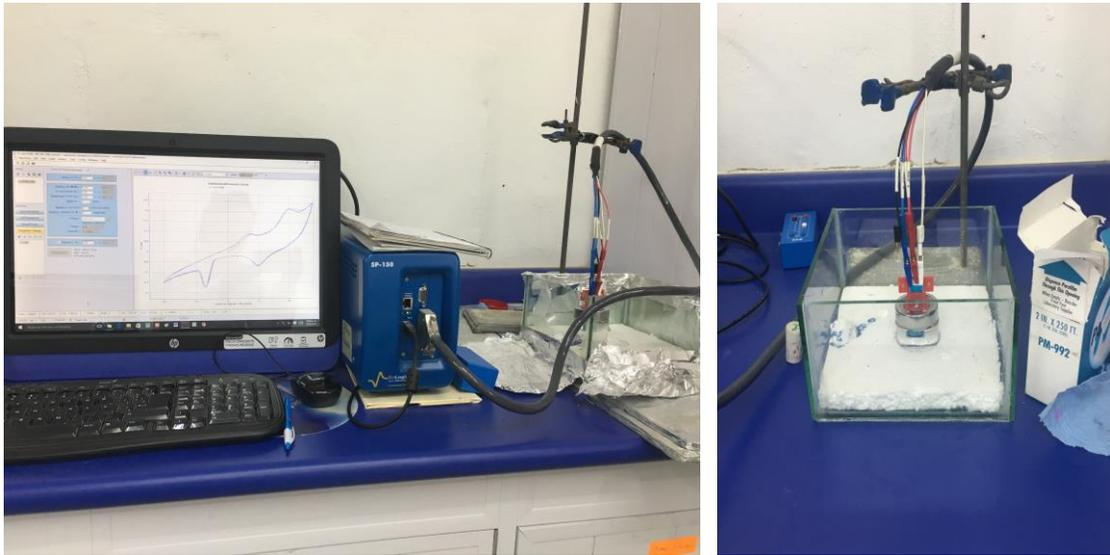
**Figura 3.17** Celda electroquímica conectada al potenciostato BIOLOGIC SP 150 con ayuda del Software EC- Lab V11. 10
