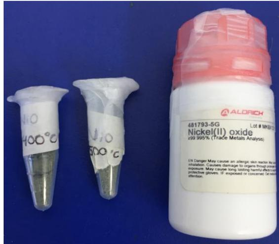
**Figura 3.10** Muestras a Caracterizar: Nickel (II) Oxide Aldrich y Oxido de Níquel realizado en el laboratorio a 400°C y 500°C
