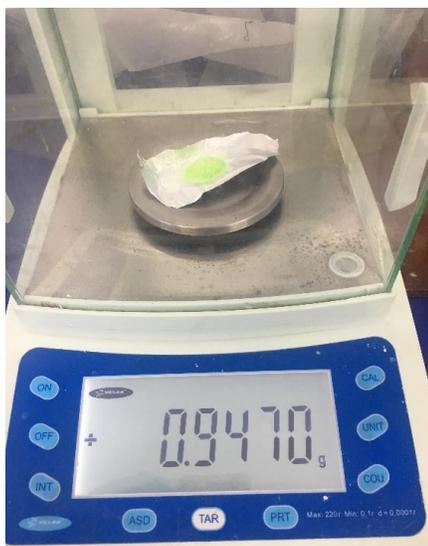
**Figura 3.1** Peso de la sal precursora de Cloruro de Níquel Hexahidratada
