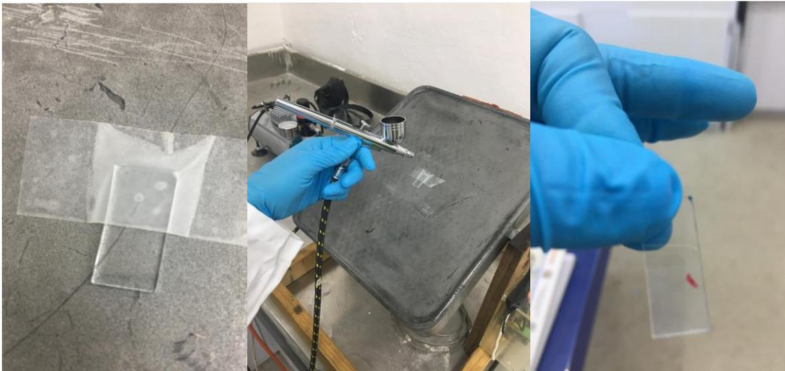
**Figura 3.23** Depósito de ITO en Vidrio de 2x1cm por Hot Spray
