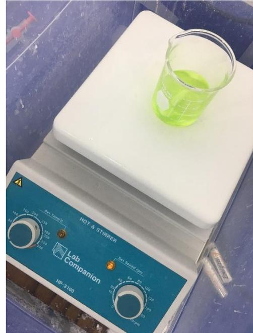
**Figura 3.4** Mezcla en Agitador Lab Companion a 15 RPM
