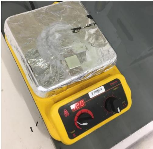
**Figura 3.33** Depósito de NiO en vidrio sobre plancha calentada a 30°C
