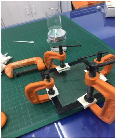
**Figura 3.30** Ensamblaje de dispositivo por medio de silicón para vidrio y aluminio
