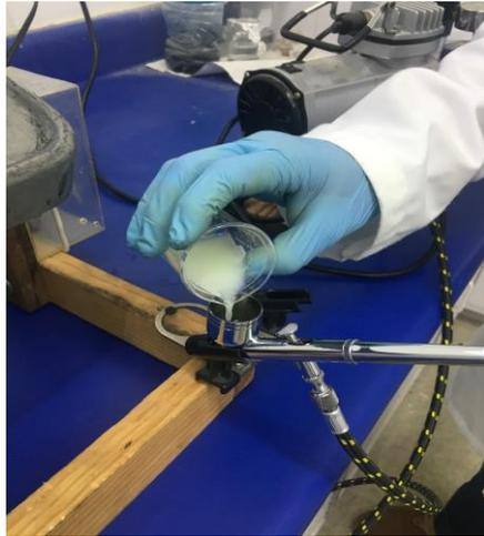
**Figura 3.20** Vaciado de mezcla en el compartimiento de aerógrafo
