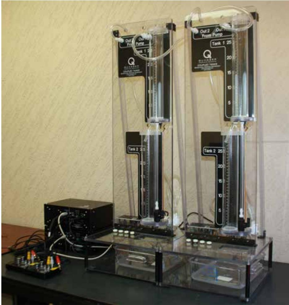
Figura 5.9: Módulos de dos tanques acoplados, módulo de acondicionamiento y tarjeta de adquisición de datos.
