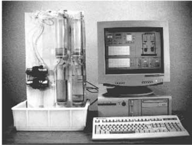
Figura 2.1: Sistema de tanques cuádruples acoplados.
