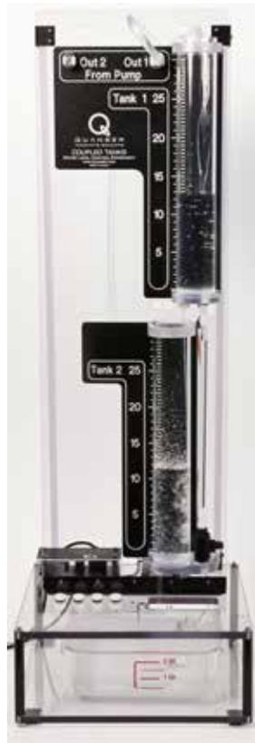
Figura 5.8: Módulo de tanques acoplados, con reservorio, bomba y manguera.
