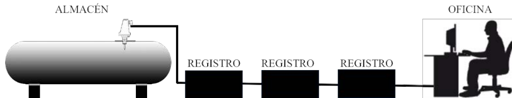
Figura 3-6. Instalación del cable de señal.
