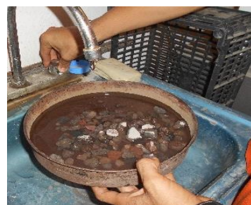
Figura 3. 28 Saturación de grava
