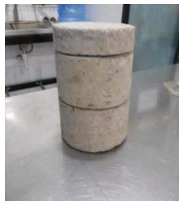
Figura 3. 73 Concreto cortado para carbonatación.
