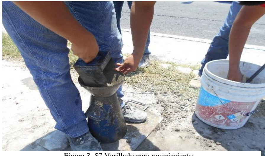
Figura 3. 57 Varillado para revenimiento
