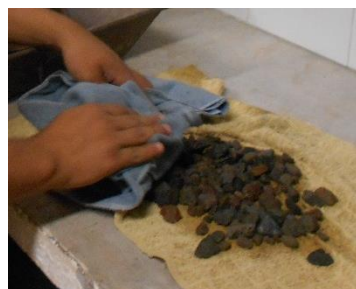
Figura 3. 29 Secado de grava
