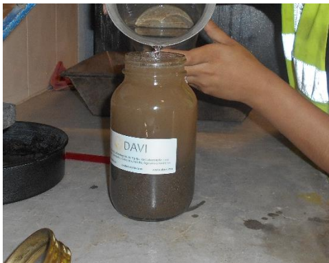
Figura 3. 31 Saturación de arena.
