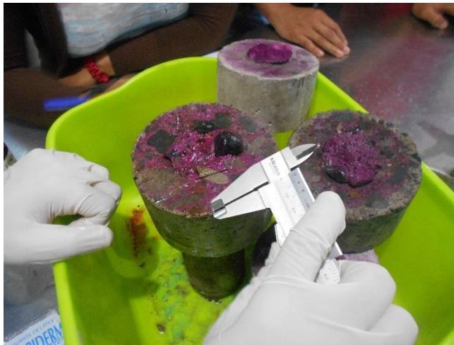
Figura 3. 75 Medición de carbonatación.
