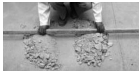
Figura 3. 18 Cuarteo de material
