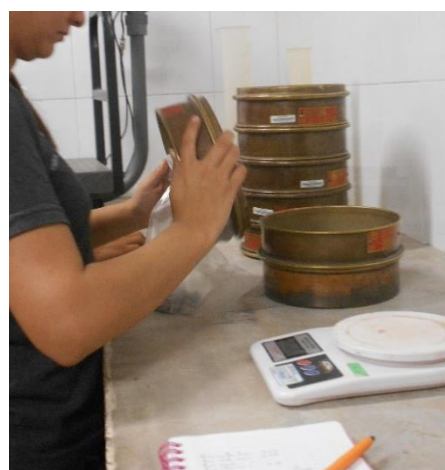
Figura 3. 22 Pesado de material por tamiz
