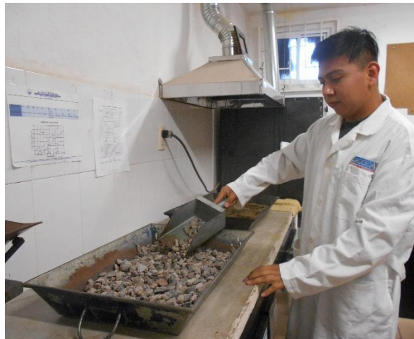
Figura 3. 11 Enfriamiento y distribución de material
