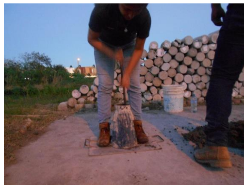
Figura 3. 56 Prueba de revenimiento
