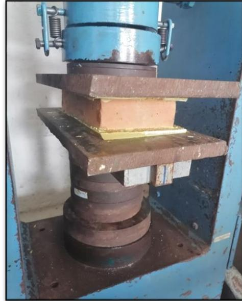
Figura 3.51 Tabique en proceso para la prueba de resistencia a la compresión
