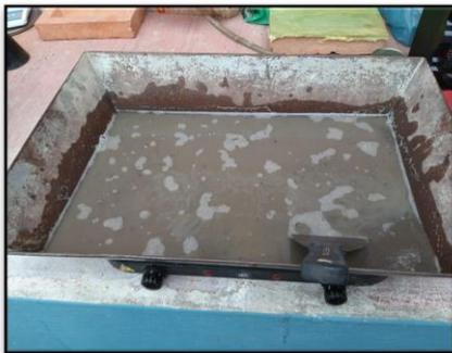
Figura 3.29 Homogenización del material
