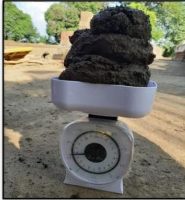
Figura 4.7 Mezcla de tabique en estado fresco.
