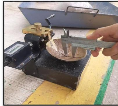
Figura 3.11 Medición de la ranura con vernier.
