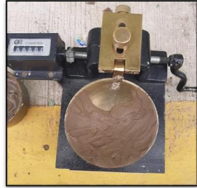
Figura 3.9 Material colocado en Copa de Casagrande
