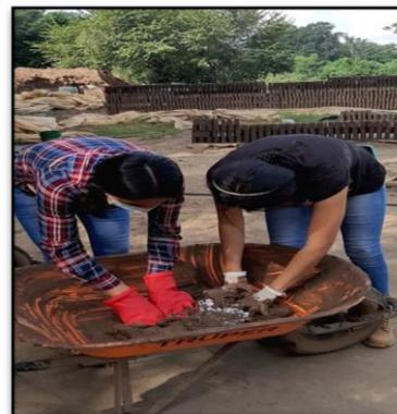
Figura 4.11 Homogenización de los materiales incluyendo sulfato de calcio.
