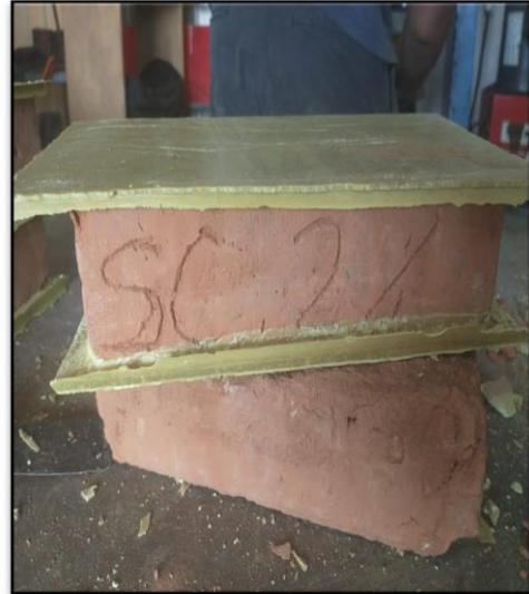
Figura 3.47 Tabique de sulfato con calcio del 2% cabeceado.
