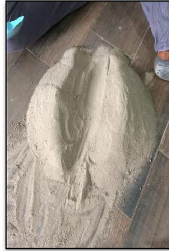
Figura 3.21 Proceso de cuarteo de material
