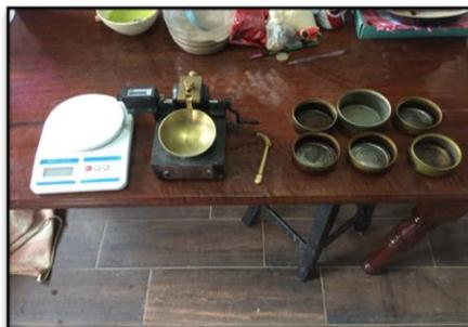
Figura 3.7 Equipo para la prueba de límite líquido.
