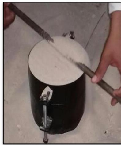
Figura 3.23 Material colocado en el molde proctor.
