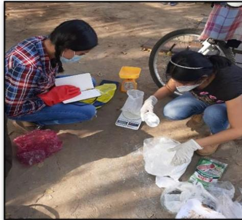
Figura 4.9 Dosificación del Sulfato de Calcio.
