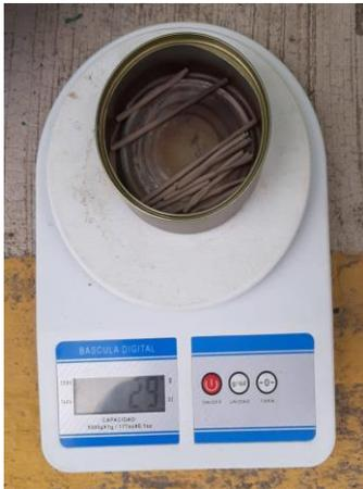
Figura 3.16 Peso de muestras en estado seco
