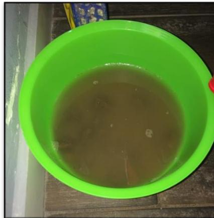
Figura 3.2 Material sumergido en agua por 24 horas  $\pm$  2.
