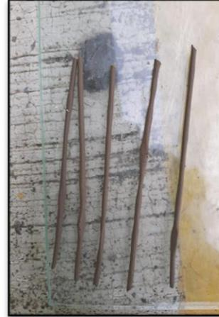
Figura 3.15 Cilindro de 3mm de diámetro.
