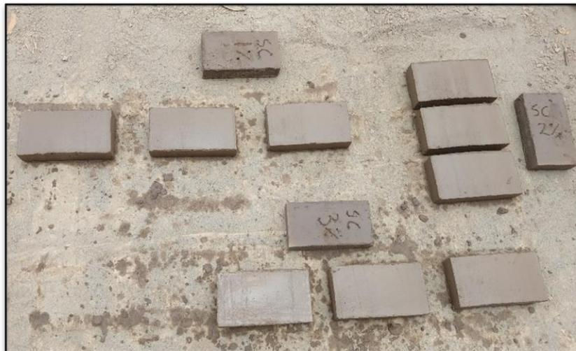
Figura 4.13 Tabiques con 1%, 2%, 3% y 4%, de Sulfato de Calcio.
