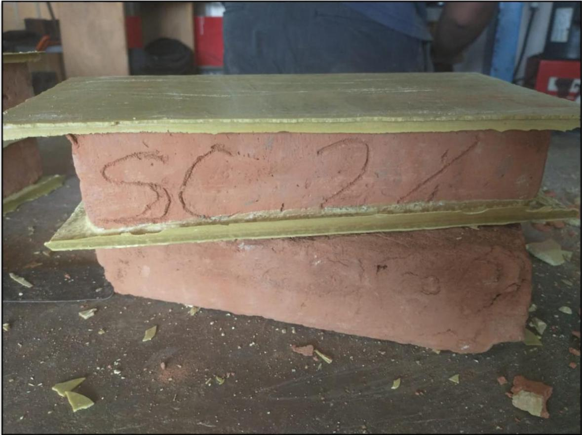
Figura 4.1 Tabique Rojo Recocido incorporando Sulfato de Calcio.
