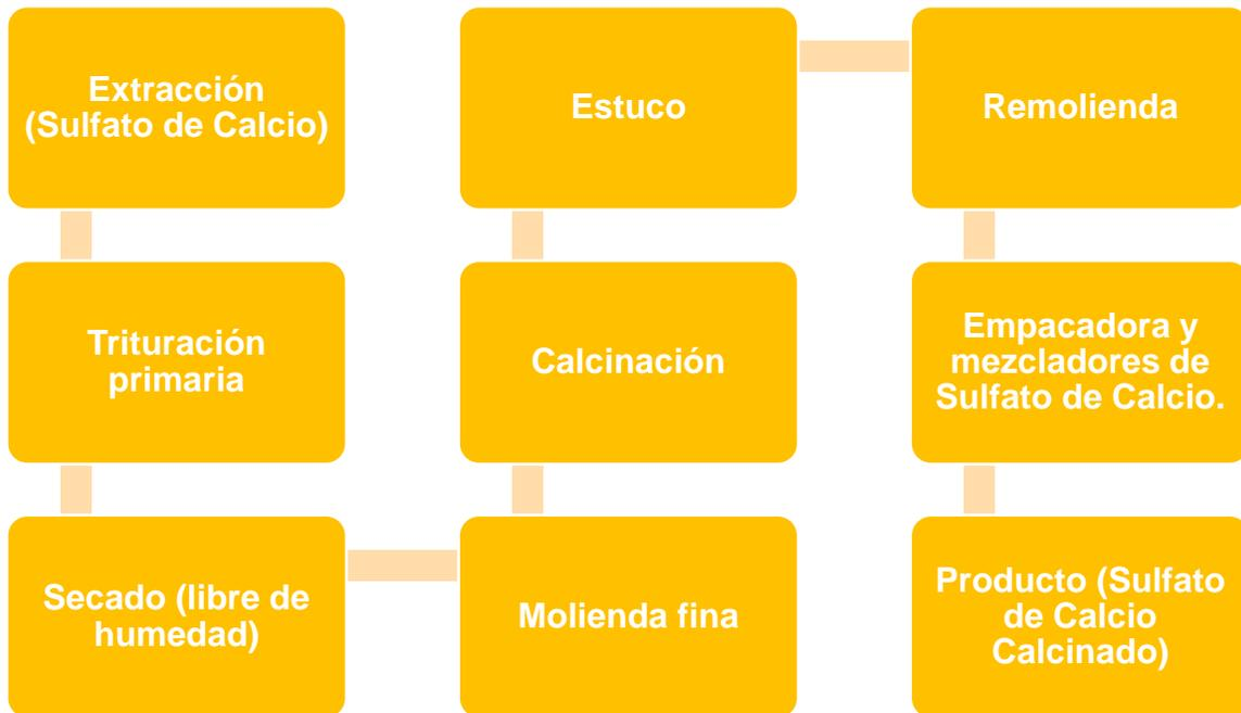
Figura 1.27 Proceso del sulfato de calcio.
