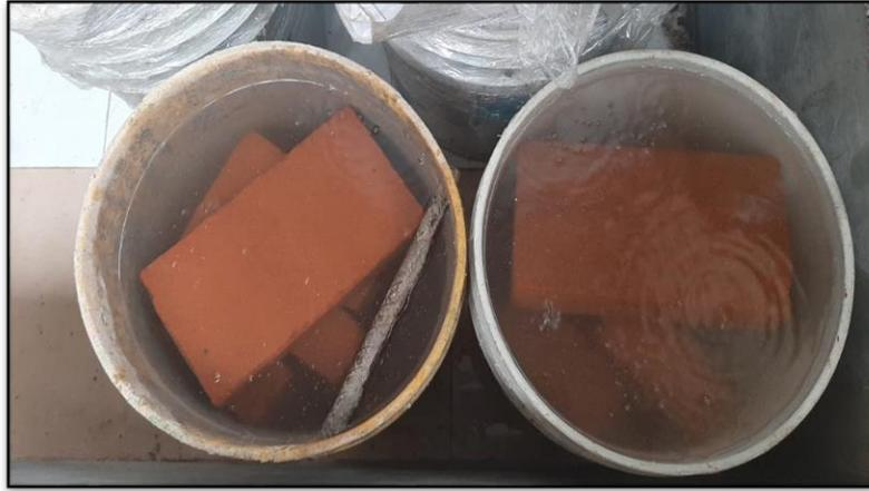
Figura 3.39 Tabique con Sulfato de Calcio sumergidos 24 horas  $\pm$  2.
