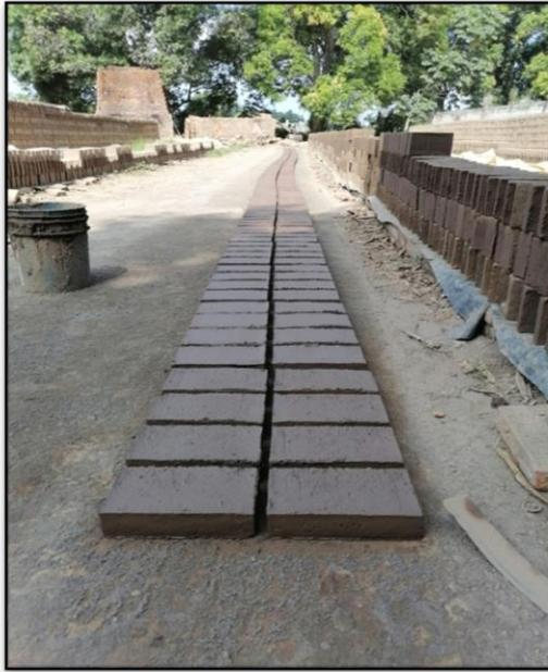
Figura 2.9 Tabiques listos para ser metido al horno.
