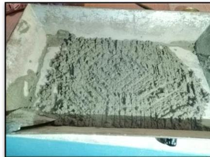
Figura 3.30 Material superficialmente seco.
