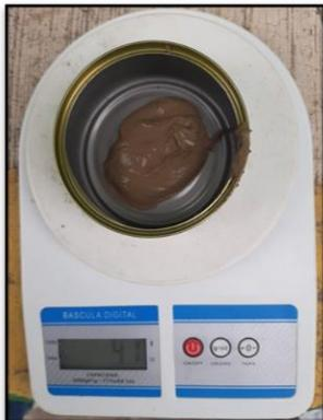
Figura 3.12 Peso de muestra húmeda
