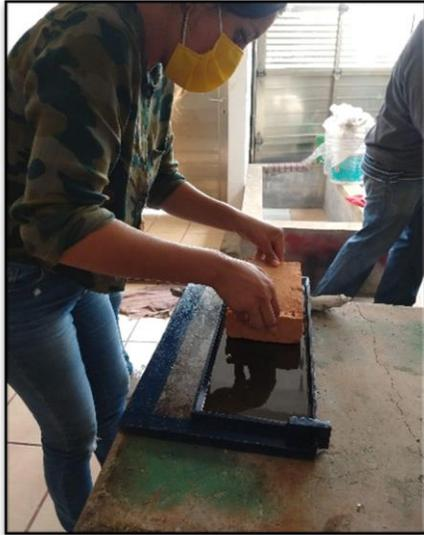
Figura 3.46 Colocación de tabique con sulfato de calcio en placa.
