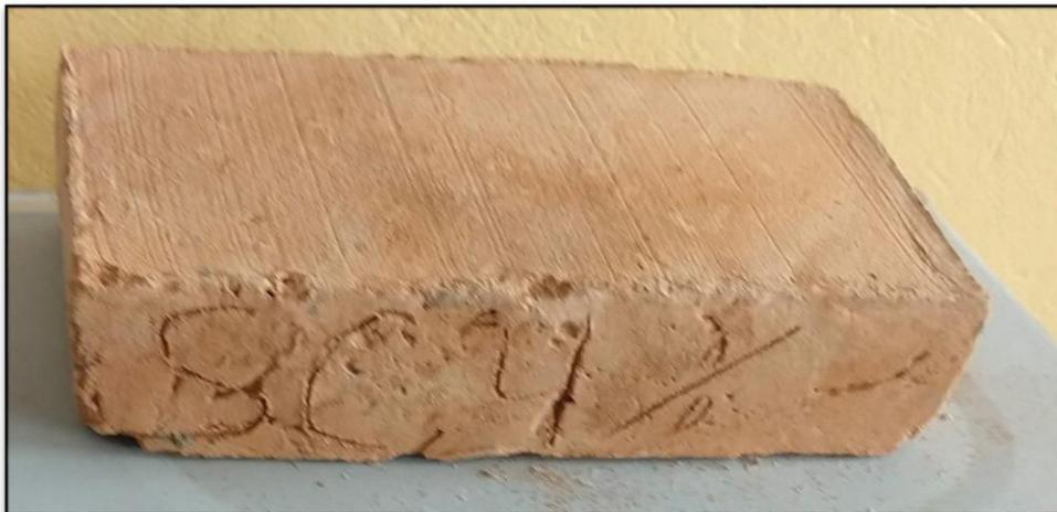
Figura 4.15 Resultado del proceso de elaboración del tabique rojo recocido incorporando sulfato de calcio.
