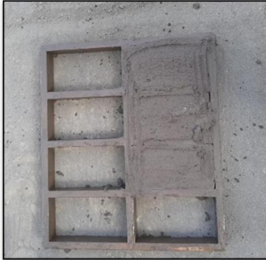
Figura 4.12 Colocación de la masa con sulfato de calcio.
