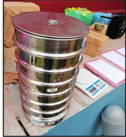
Figura 3.4 Material colocado en los tamices
