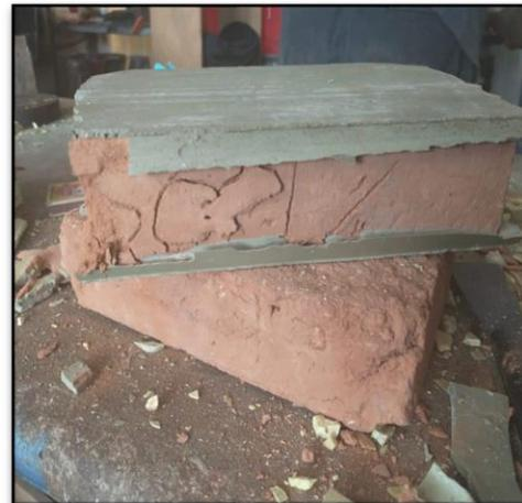
Figura 3.53 Resultado de la pieza mediante la prueba de resistencia a compresión.
