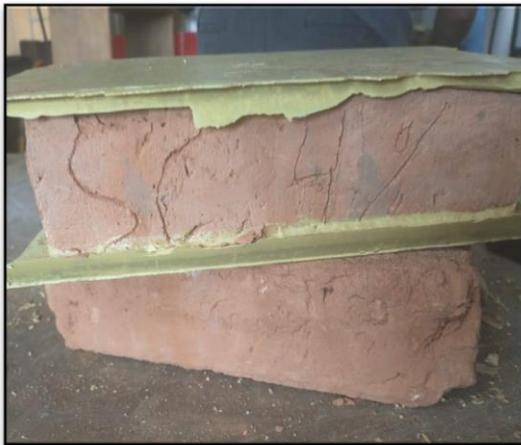
Figura 3.48 Tabique de sulfato con calcio del 4 % cabeceado.
