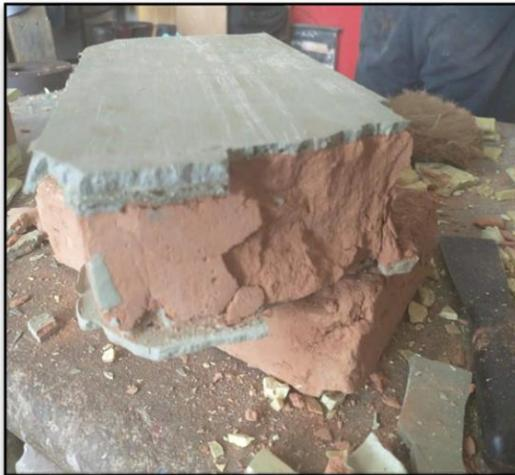
Figura 3.52 Resultado de la prueba de resistencia a la compresión.
