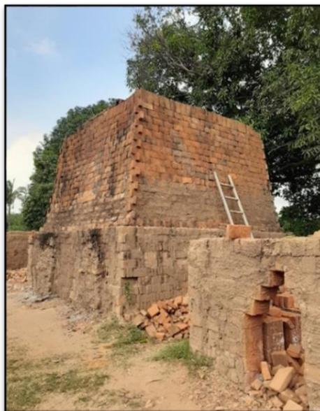
Figura 2.10 Horno preparado para cocción de tabiques.
