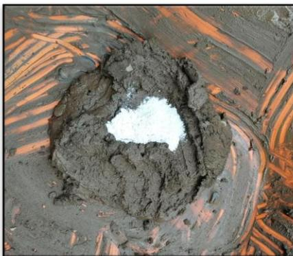
Figura 4.10 Adición de sulfato de calcio a la masa.
