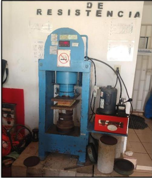
Figura 3.50 Máquina resistencia a la compresión
