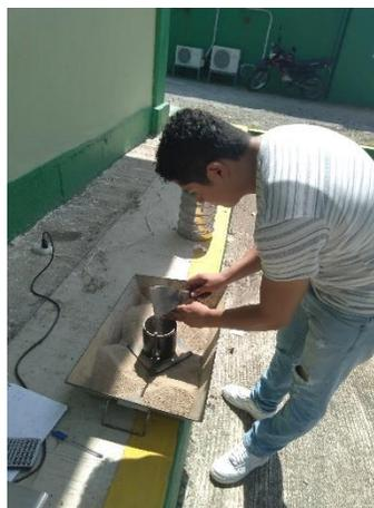
Fig. 4. 32 Vaciado de material en molde.
