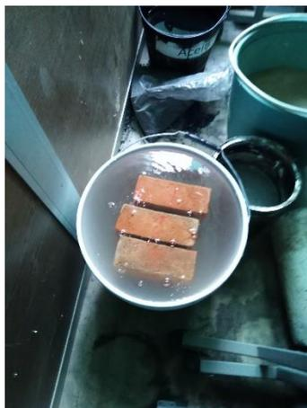
*Fig. 4. 49 Colocación de tabiques en agua.*
