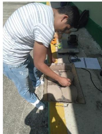
*Fig. 4. 23 Secado de material Fig. 4. 24 Colocación vidrio de reloj. Fig. 4. 25 Cuarteo de material*
