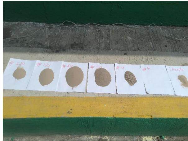
Fig. 4. 30 Material pesado por N° de malla.
