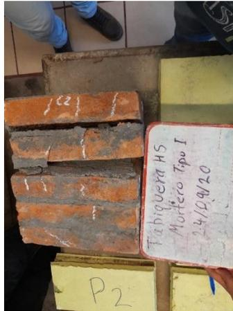
*Fig.5. 8 Pila ensayada.*
