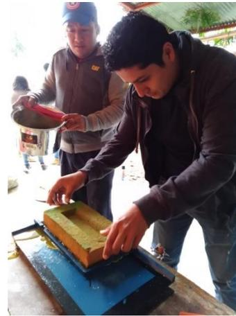
*Fig. 4. 53 Disgregado de material Fig. 4. 54 Colocación de azufre. Fig. 4. 55 Colocación de pieza*
