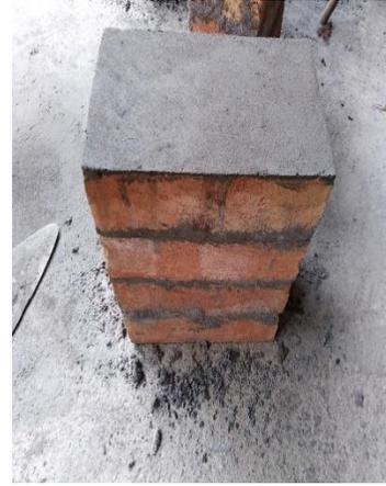
*Fig. 4. 79 Aplanado de pila.*
