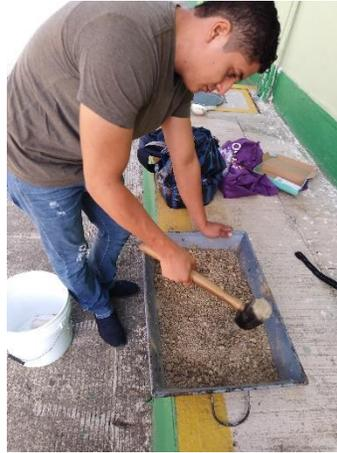
*Fig. 4. 5 Disgregado de material.*
