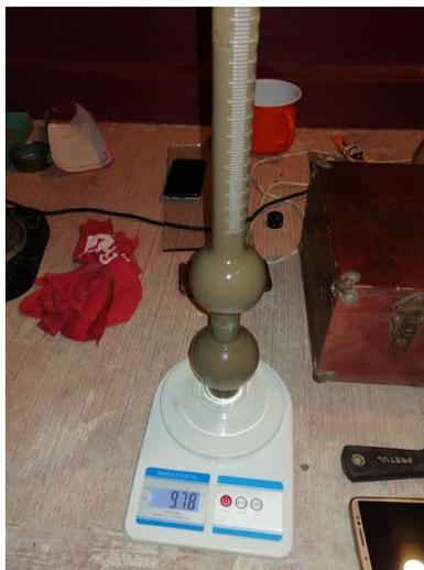
Figura IV.15 Registro de la masa del material mas el matraz de Chapman.
