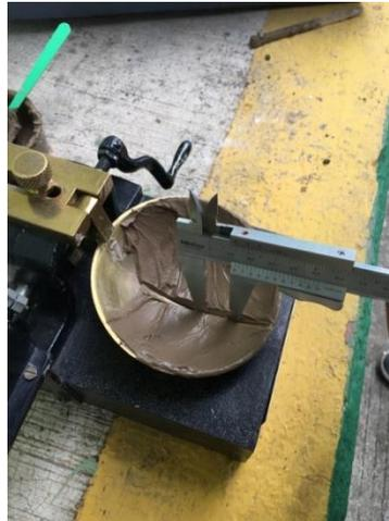
*Figura IV.22 Medida de cierre del talud del material por causa de golpes.*
