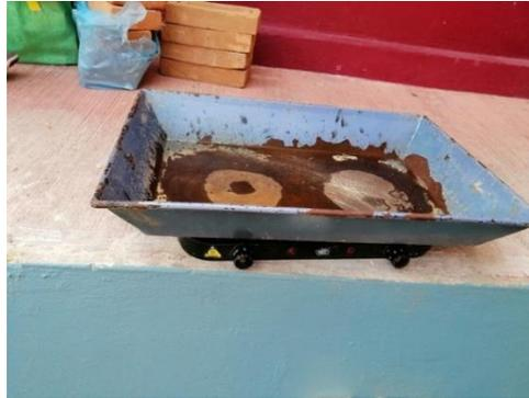
Figura IV.18 Muestra de material retenido expuesto al calor para perdida de humedad.
