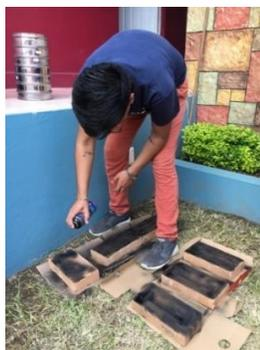
Figura IV.30 Roció de una ligera capa de pintura en aerosol sobre los especímenes.
