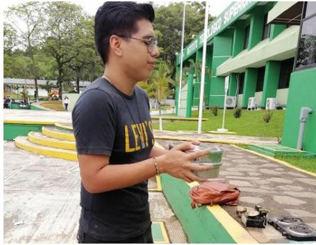
Figura IV.20 Tamizado del material sobre la malla no.40.
