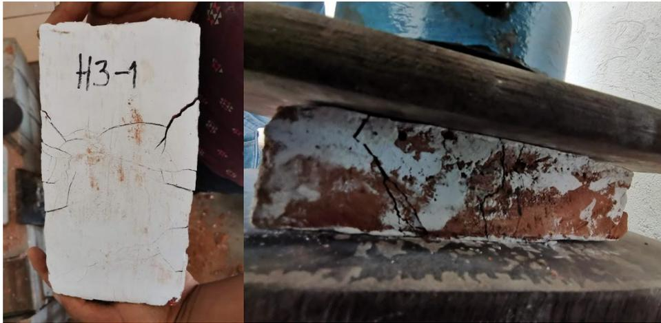
Figura IV.42 Tabique sometido a compresión axial.
