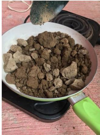
Figura IV.16 Secado del material arcilloso.
