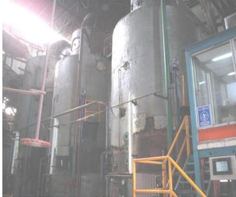
Figura II.18 Silos de evaporación para obtener meladura.
