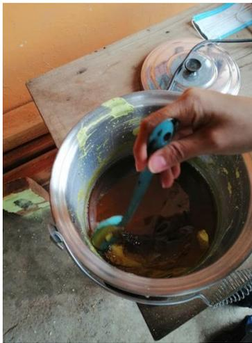
Figura IV.31 Azufre expuesto al calor para obtener un estado líquido.
