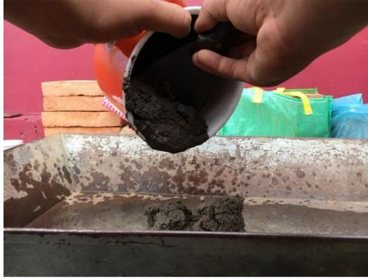
Figura IV.9 Secado de material por medio de una parrilla eléctrica.
