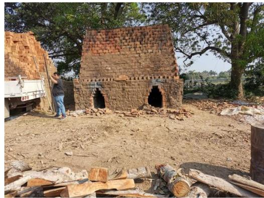
Figura V.24 Cocción de tabiques en horno artesanal.
