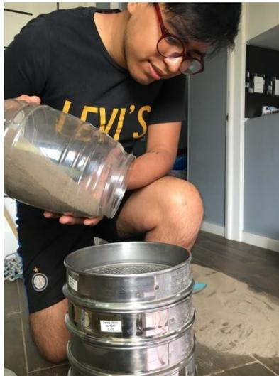
Figura IV.5 Vertido del material sobre el juego de tamices,
