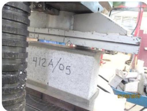
Figura II.9 Resistencia a la compresión de piezas de mampostería.
