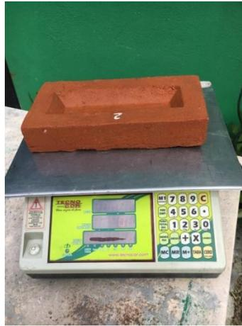
Figura IV.29 Registro del nuevo peso del tabique saturado.
