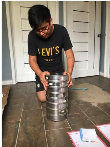
Figura IV.6 Tamizado del material.
