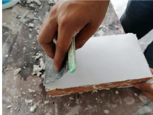
Figura IV.39 Extendido de yeso sobre espécimen de tabique.
