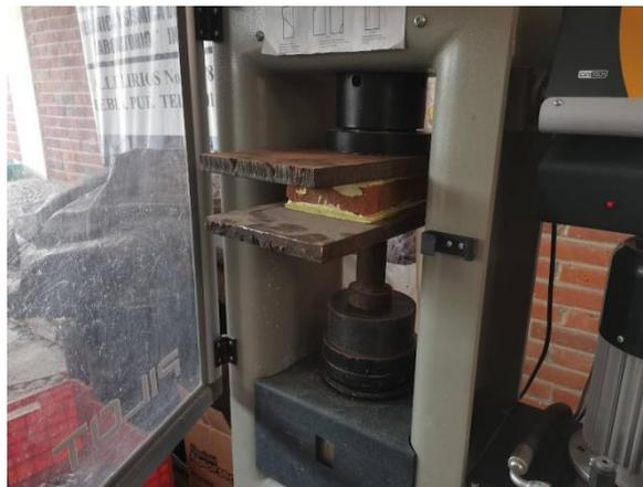
Figura IV.41 Colocación el tabique sobre la placa de compresión axial.
