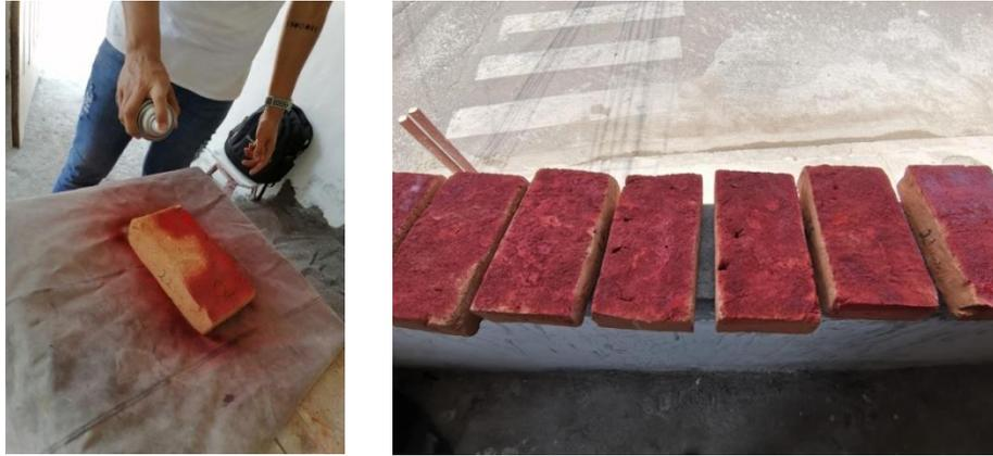
Figura IV.37 Roseado y secado de la pintura en aerosol sobre los tabiques.
