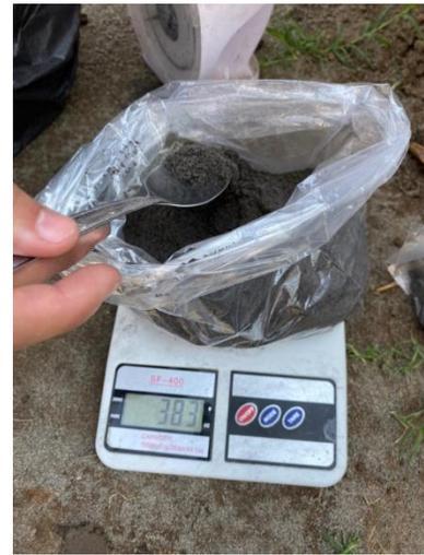
Figura V.16 Preparación de las porciones de material a adiconar.
