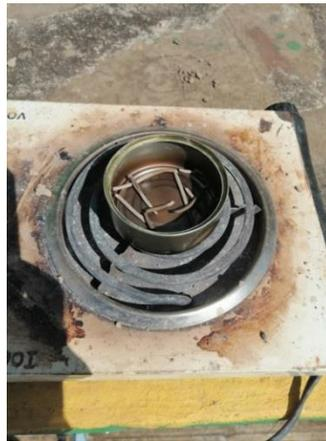
Figura IV.26 Material expuesto al fuego para perdida de humedad.
