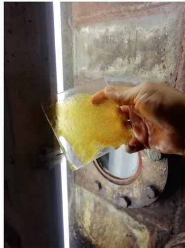
Figura II.19 Templa formada en tachos de vacío.
