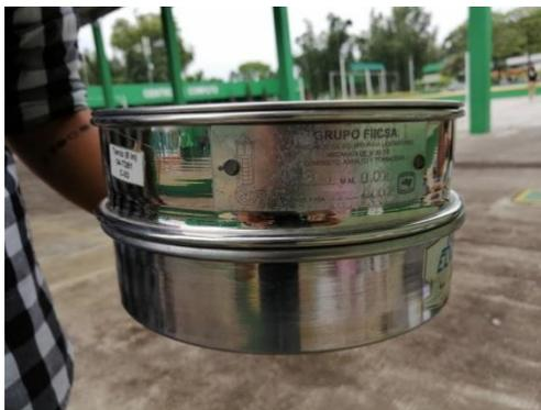
Figura V.14 Tamizado de muestra de CBCA.
