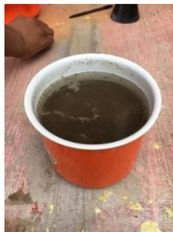
Figura IV.8 Saturación del material.
