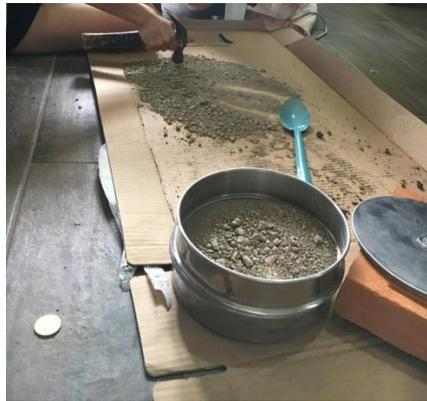
Figura IV.2 Disgregado de material.
