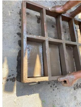
Figura V.21 Desmoldeado del material.
