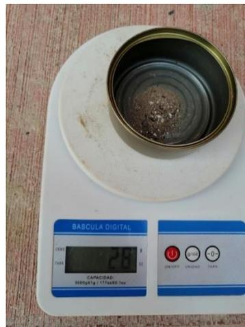
Figura IV.19 Registro de la masa del material retenido en las mallas.
