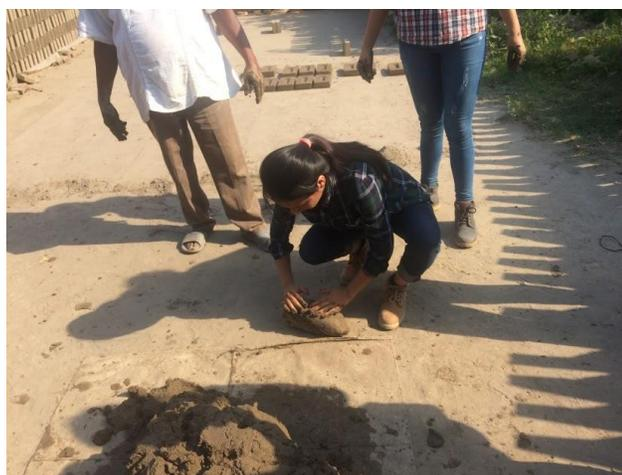
Figura III.11 Amasado de la pieza de tabique.
