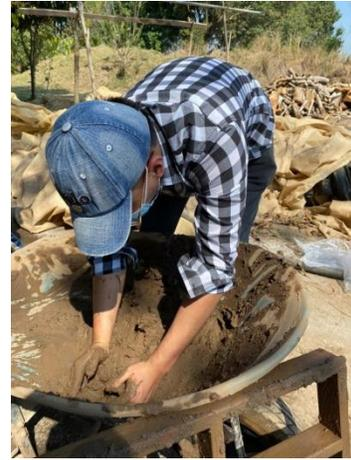
Figura V.17 Amasado de la arcilla con los aditamentos.
