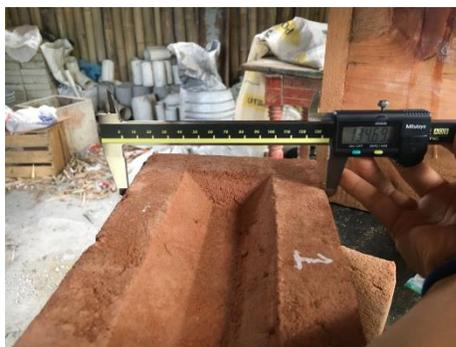
Figura IV.27 Toma de medidas del tabique con ayuda de un vernier.
