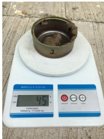
*Figura IV.23 Muestra del material de la capsula, pesado y registrado.*
