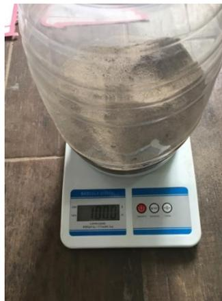
Figura IV.4 Peso de la muestra de material.
