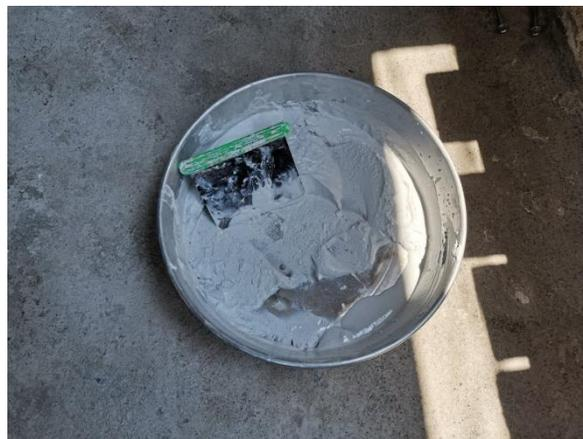
Figura IV.38 Mezcla de yeso homogeneizado sobre recipiente de aluminio.
