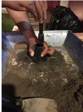
Figura IV.11 Compactación de material en cono troncocónico.
