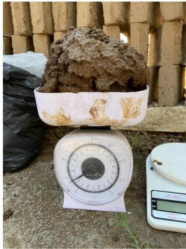
Figura V.15 Peso de la masa equivalente a un tabique.
