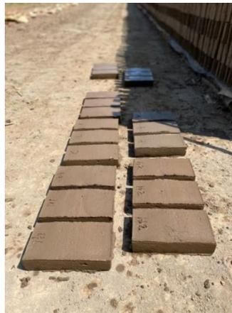
Figura V.22 Tabiques recién desmoldeados reposados sobre el suelo.
