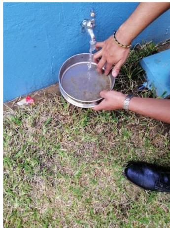
Figura 50 Lavado de material sobre la malla 200.
