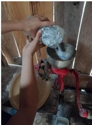
Figura V.8 Molino de mano utilizado para la molienda de hueso.
