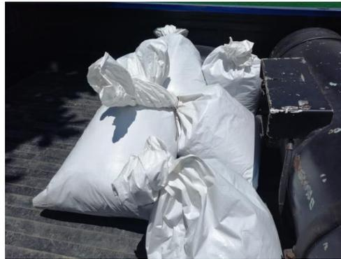
Figura V.11 Ceniza de bagazo de caña de azúcar recolectada del Ingenio "El Modelo".
