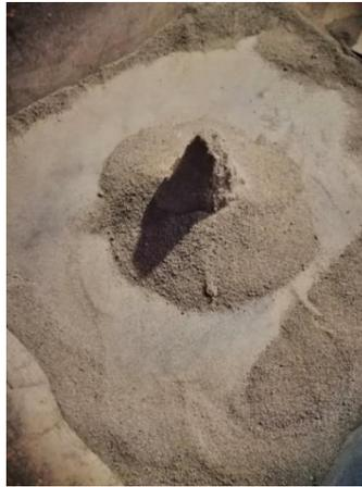
Figura IV.12 Consistencia del material arenoso al retirar el molde.
