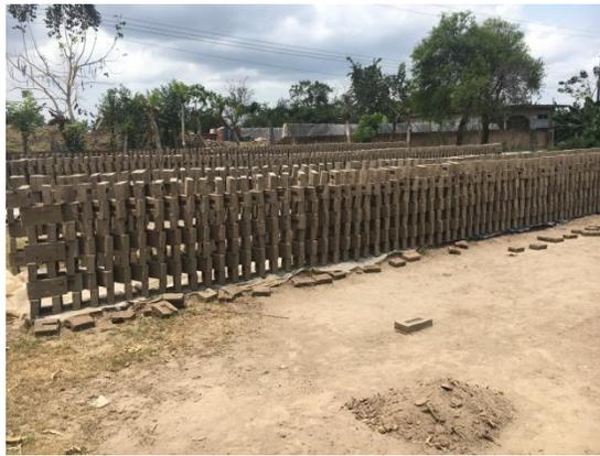
Figura III.12 Estivación de tabiques previamente a la cocción.
