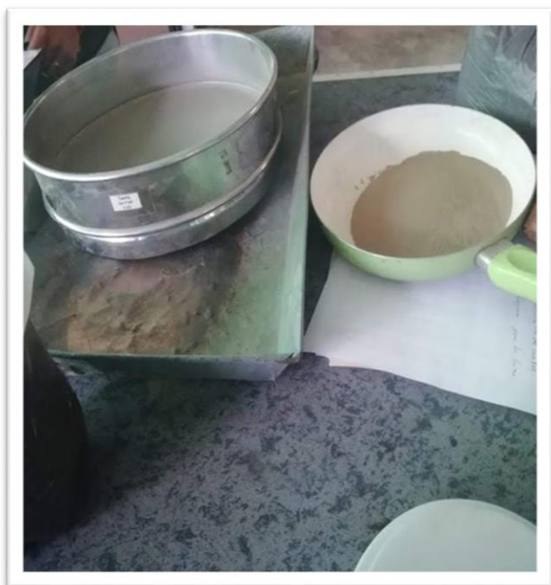
Figura 4. 8 Arcilla previamente cernida por la malla No. 200 (Autor propio)
