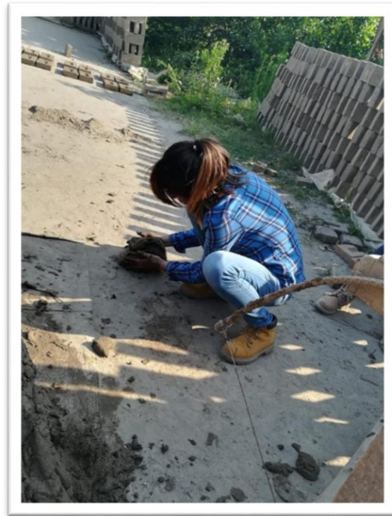
Figura 3. 12 Separando porciones de la mezcla para introducir en la gavera (Autor propio)
