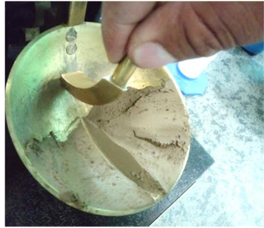
Figura 4. 10 Ranuración de la pasta (Autor propio)
