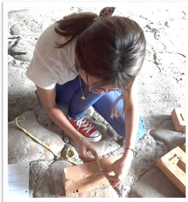
Figura 4. 22 Medición del mampuesto (Autor propio)
