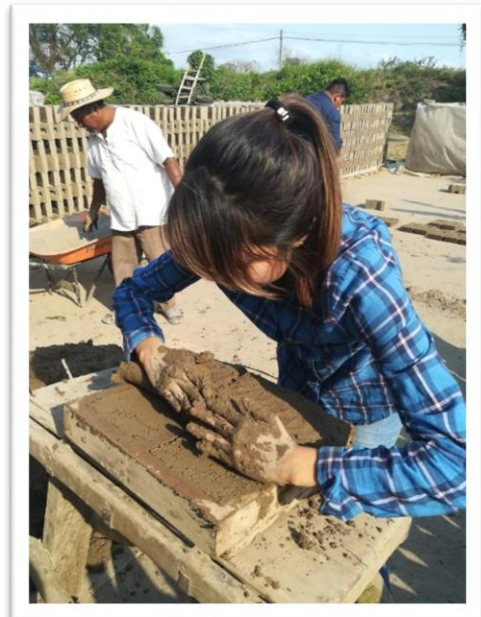
Figura 3. 15 Eliminación de excedente de la masa (Autor propio)
