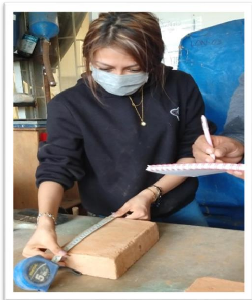
Figura 5. 12 Determinación del dimensionamiento de las piezas (NMX-C-038-ONNCCE-2013) (Autor propio)
