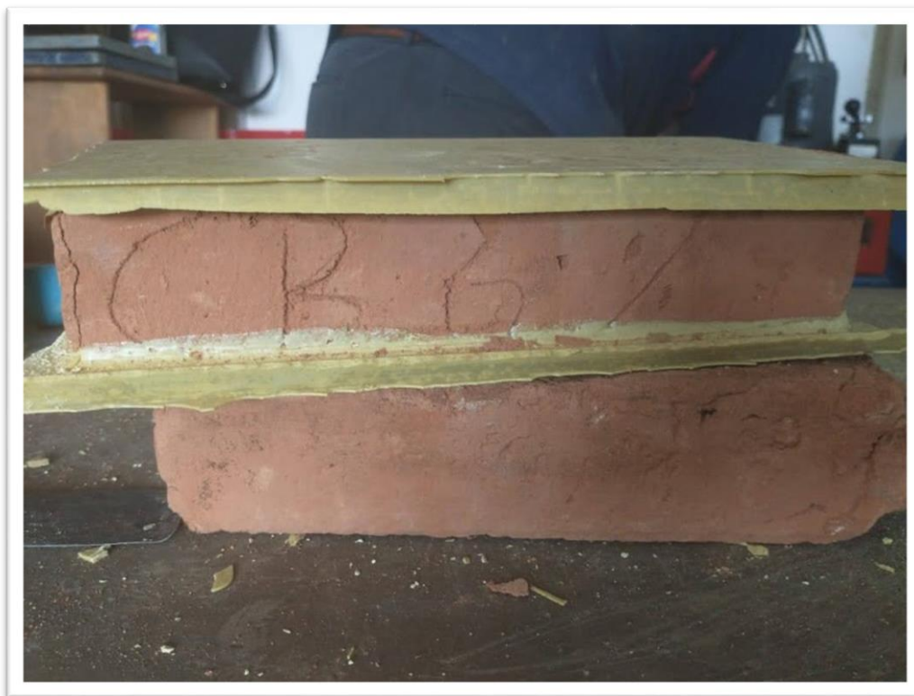
Figura 5. 1 Pieza de tabique modificada lista para ensayar en la máquina de compresión axial (Autor propio)
