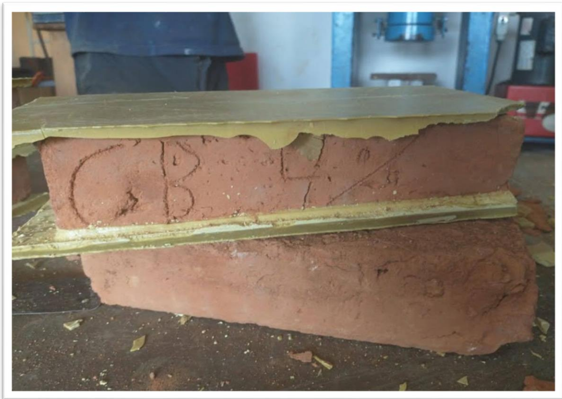
Figura 4. 31 Tabique modificado encarado por ambas partes (Autor propio)
