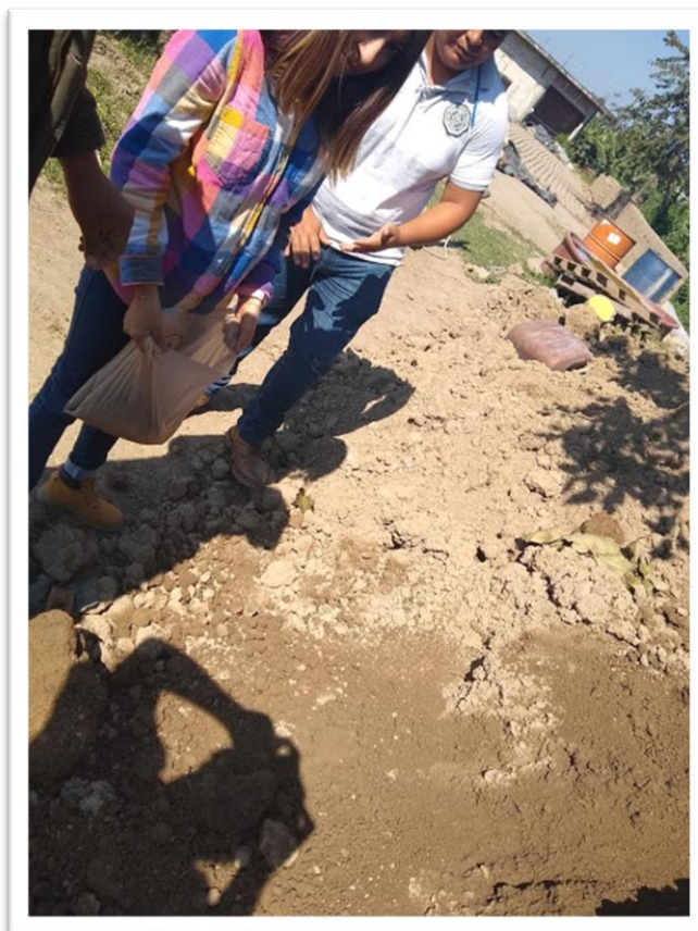
Figura 4. 1 Extracción de la muestra de arcilla para analizar
