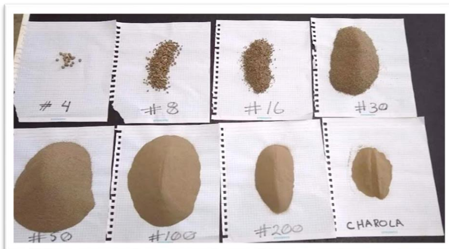
Figura 4. 19 Material de obtenido del cribado de los tamices (Autor propio)
