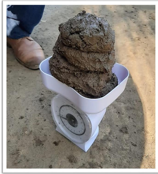
Figura 5. 4 Peso de una porción de la mezcla equivalente a un tabique (Autor propio)
