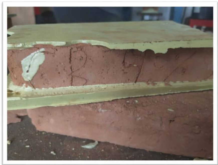
Figura 4. 33 Tabique de CBCA ensayado (Autor propio)
