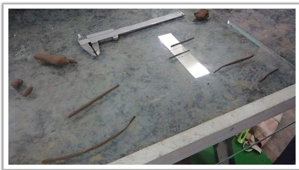
Figura 4. 15 Cilindros formados con la mezcla arcillosa (Autor propio)
