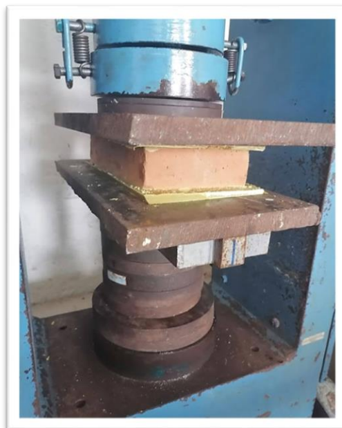
Figura 5. 15 Determinación de la resistencia a la compresión axial de los tabiques (NMX-C-036-ONNCCE-2013) (Autor propio)
