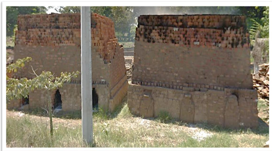
Figura 5. 11 Hornos tradicionales de la tabiguera Zamora (Autor propio)
