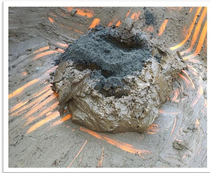
Figura 5. 6 Incorporación de C.B.C.A. a la mezcla (Autor propio)
