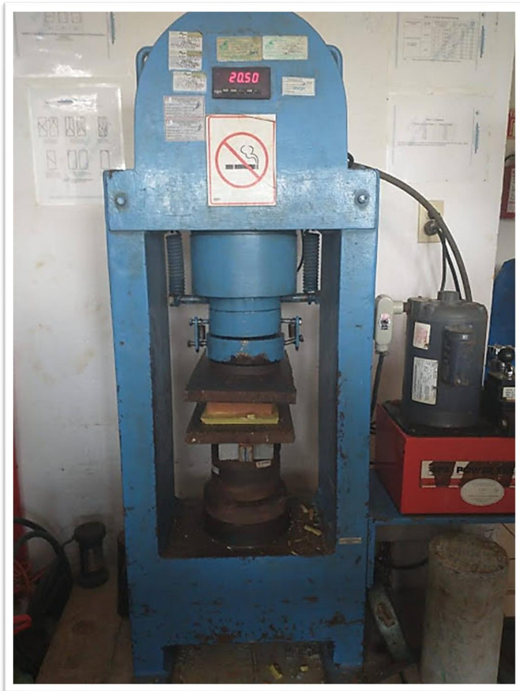
Figura 4. 34 Máquina de compresión axial del laboratorio LACOCA (Laboratorio de Control de Calidad) (Autor propio)
