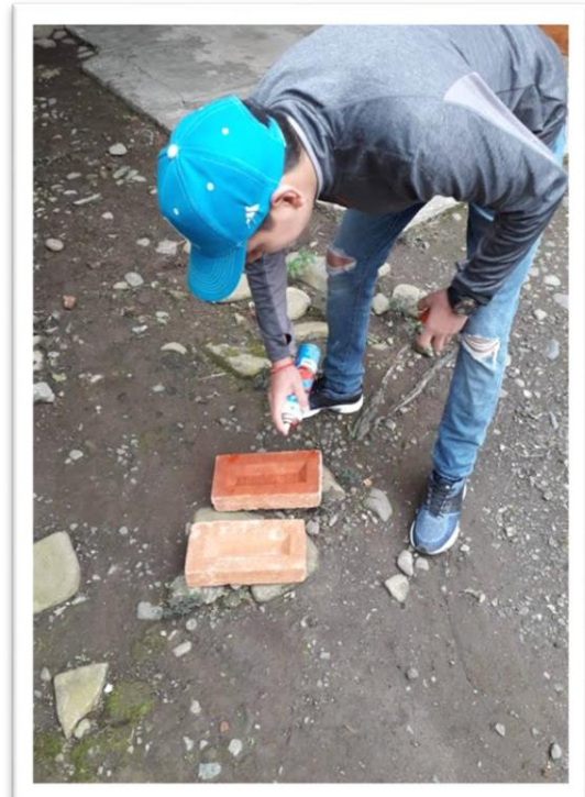
Figura 4. 27 Colocación de pintura epóxica al tabique (Autor propio)
