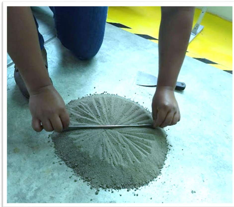
Figura 4. 6 Cuarteo con ayuda de una varilla punta de bala (Autor propio)
