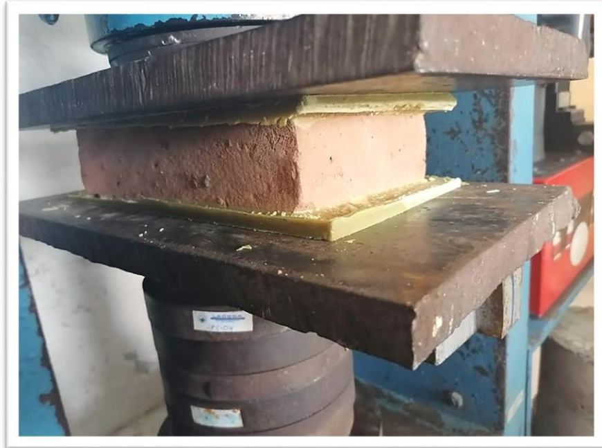
Figura 4. 32 Ejecución de la prueba de compresión sobre el prototipo (Autor propio)
