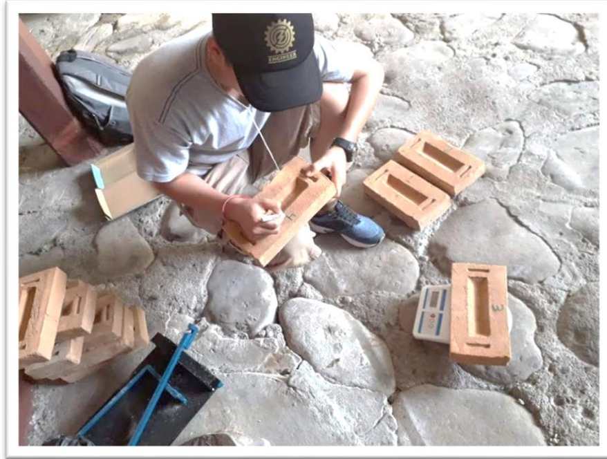
Figura 4. 21 Pesado de tabiques convencionales (Autor propio)
