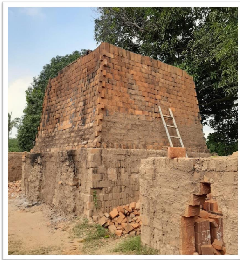
Figura 3. 5 Horno donde se lleva a cabo la cocción de los mampuestos (Autor propio)
