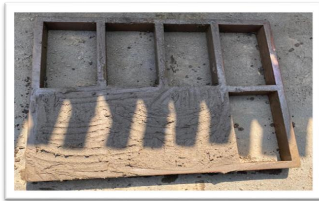
Figura 3. 14 Gavera hueca de madera (Autor propio)
