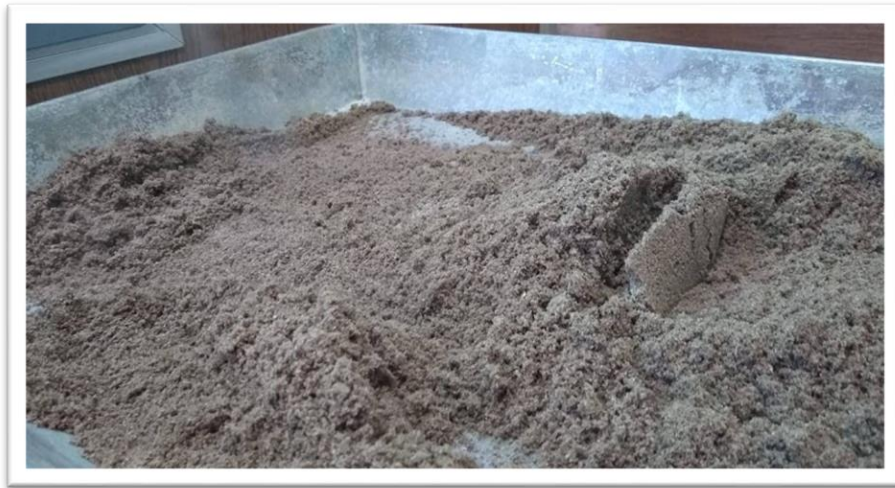
Figura 4. 18 Secado de la arena (Autor propio)
