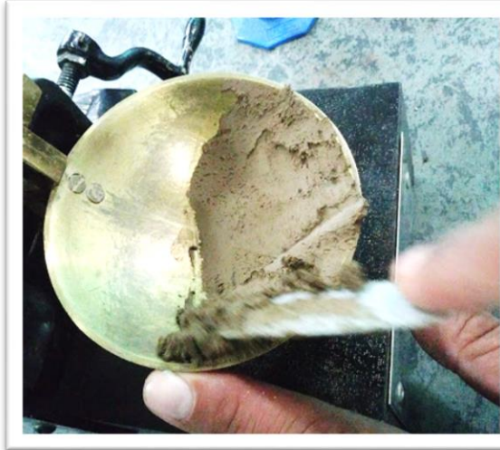
Figura 4. 11 Colocación de la copa de Casagrande con la mezcla (Autor propio)
