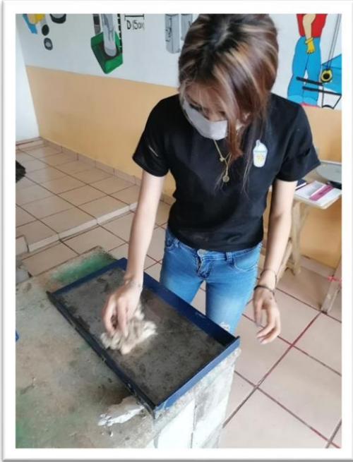
Figura 4. 30 Lubricación de la placa cabeceadora (Autor propio)
