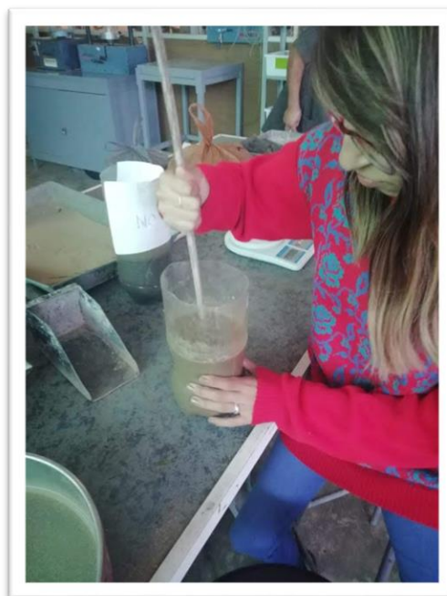
Figura 4. 7 Homogenización de la arcilla con movimientos oscilatorios (Autor propio)
