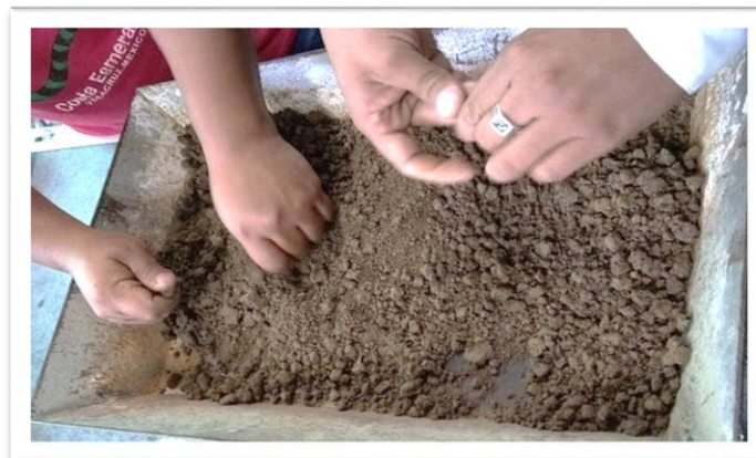
Figura 4. 4 Disgregado del material
