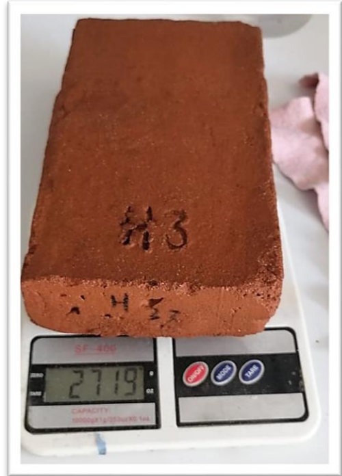
Figura 4. 23 Pesado de la pieza en estado húmedo (Autor propio)
