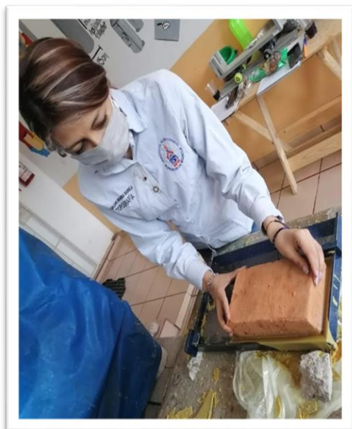
Figura 5. 14 Cabeceo de la pieza a ensayar (Autor propio)
