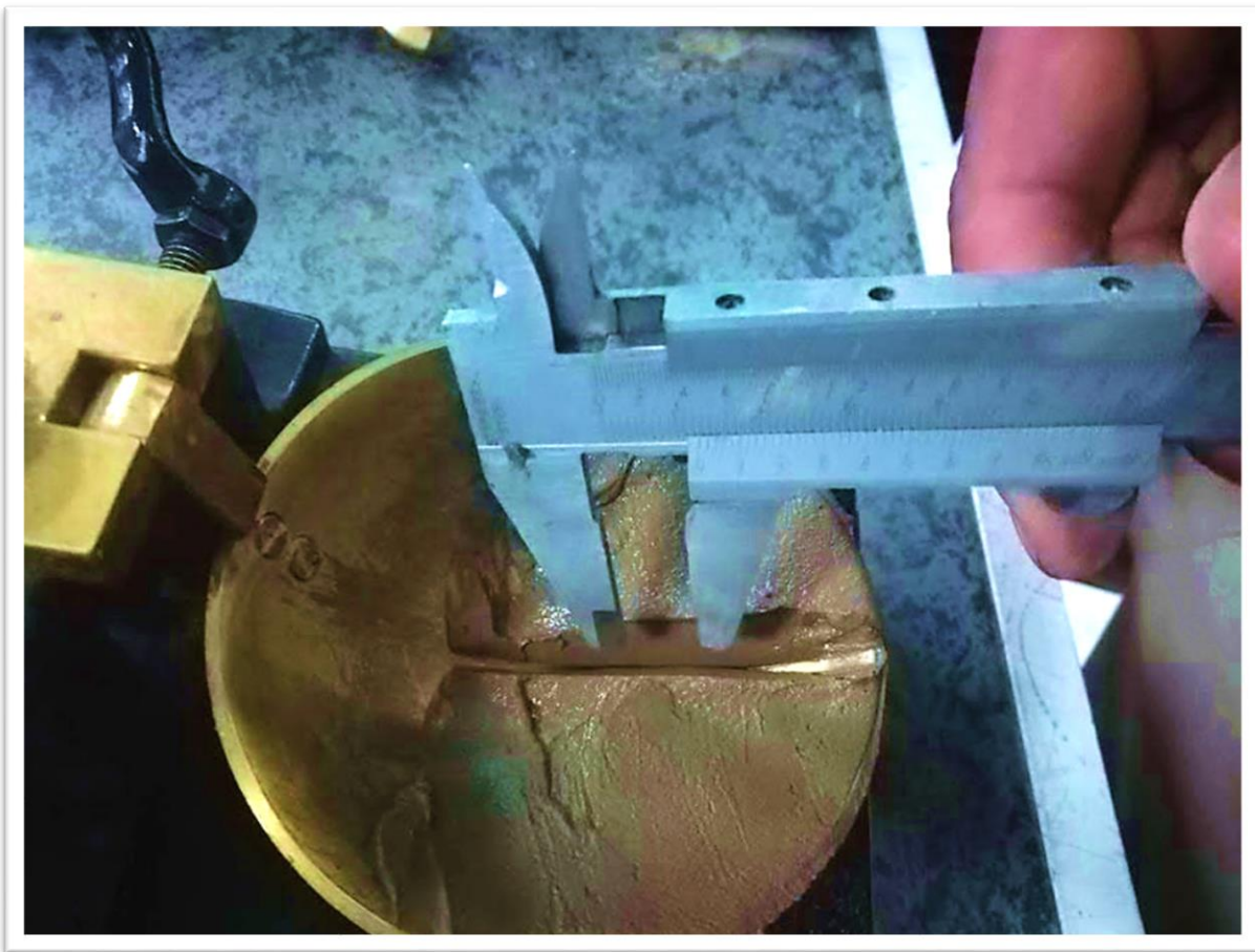
Figura 4. 12 Medición de la abertura con Vernier (Autor propio)
