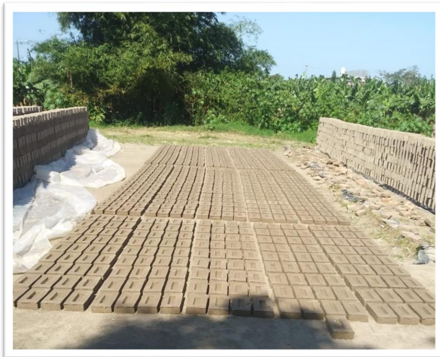
Figura 3. 7 Piezas crudas en proceso de secado (Autor propio)
