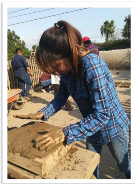
Figura 3. 16 Colocación de la composición dentro del molde (Autor propio)
