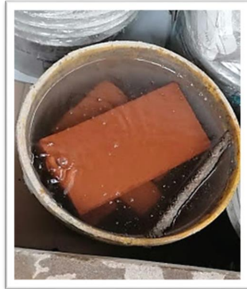
Figura 5. 13 Determinación de la absorción de las piezas (NMX-C-037-ONNCCE-2005) (Autor propio)
