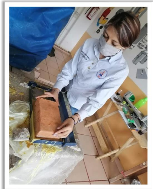
Figura 4. 29 Colocación del mampuesto sobre el azufre fundido (Autor propio)
